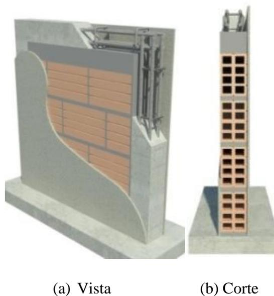
**Figura 4:** Vedação com bloco cerâmico. Fonte: Pedroso (2015).
