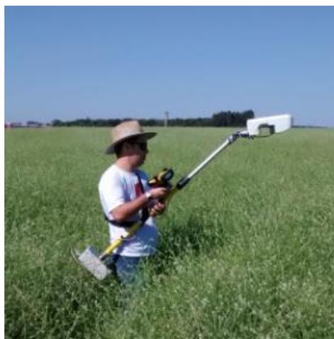
Figura 4 Posicionamento do sensor Greenseeker® 505 Handheld para coleta de informações espectrais.
