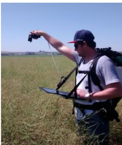
Figura 2 Posicionamento do sensor FieldSpec® 4 Hi-Res, modo passivo para coleta de informações espectrais.
