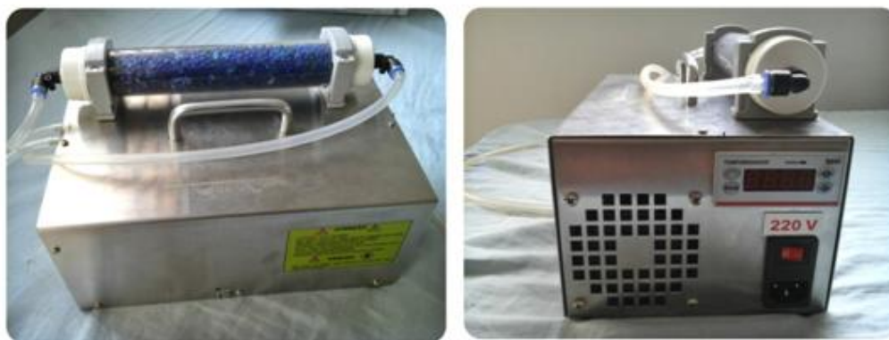
Figura 2 Gerador de ozônio utilizado (Ozônio Line).
