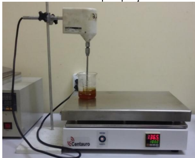
FIGURA 7. Síntese da nanopartícula magnética de óxido de ferro obtida pelo método da coprecipitação
