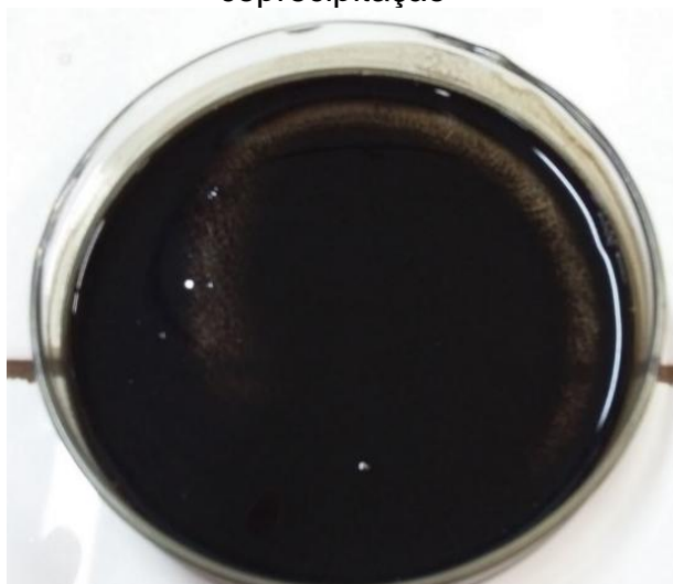
FIGURA 8. Precipitado sólido de óxido de ferro obtido pelo método da coprecipitação
