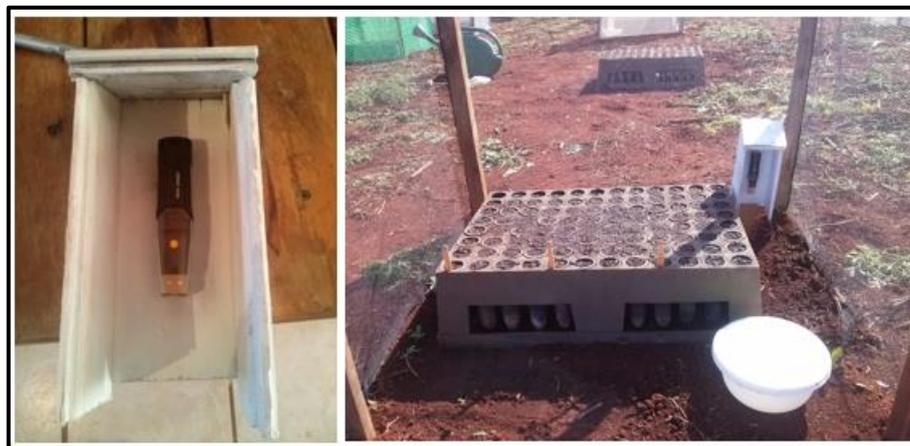
**Figura 2** - Dataloggers instalados em cada nível de sombreamento para o monitoramento da temperatura e umidade relativa do ar, no período de 30/07 a 16/10/14. Unioeste, *Campus* Marechal Cândido Rondon, PR. 2016.
