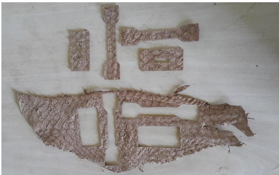
**Figura 1.** Retirada do corpo de prova nos sentidos longitudinal e transversal.
