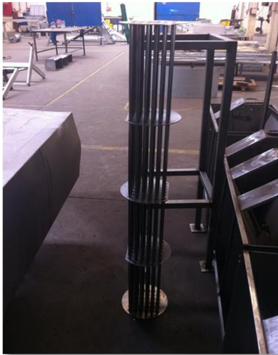
Figura 4.17 - Processo de fabricação do condensador. Fonte: Resultado da pesquisa.
