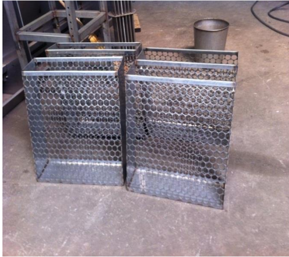
Figura 4.16 - Processo de fabricação do leito extrator. Fonte: Resultado da pesquisa.
