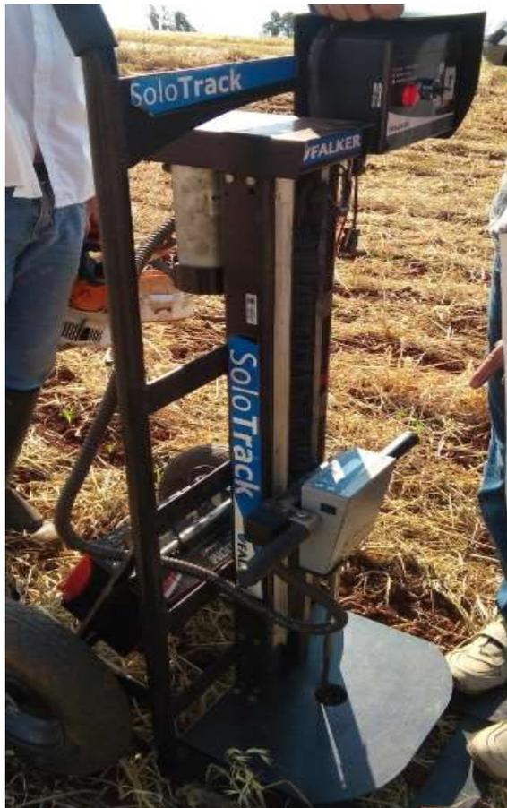
Figura 3 Penetrômetro Digital Falker PenetroLOG.
