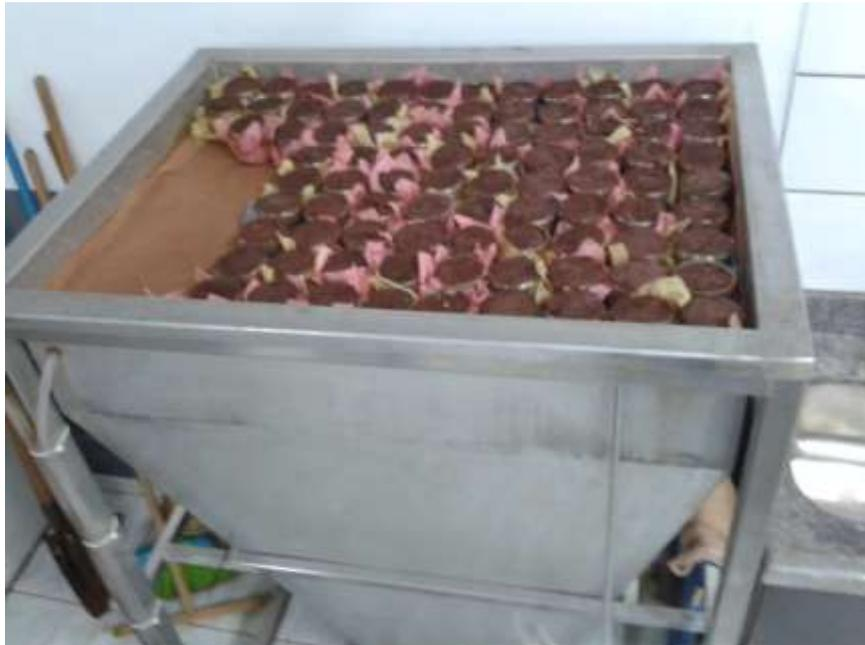
Figura 4 Drenagem da água das amostras não deformadas em mesa de drenagem.
