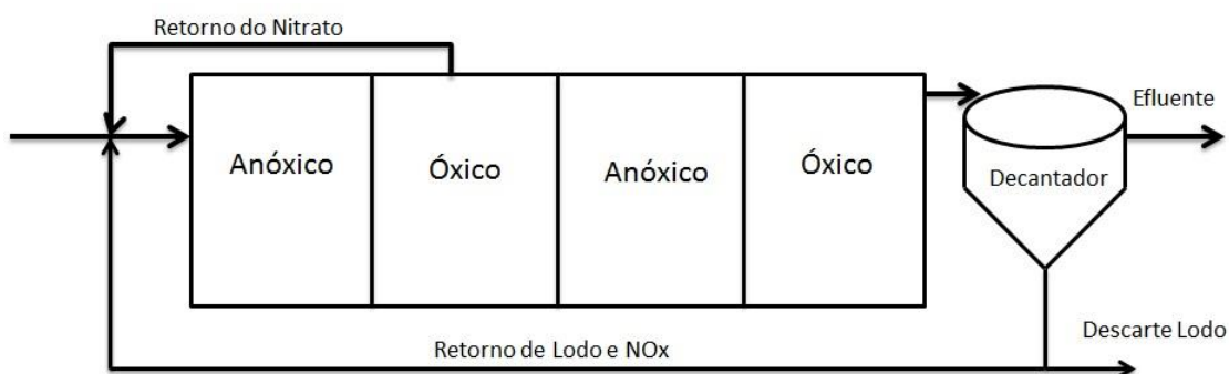
Figura 3 Representação de um sistema utilizando o processo Bardenpho. Fonte Adaptação Metcalf & Eddy (2003).
