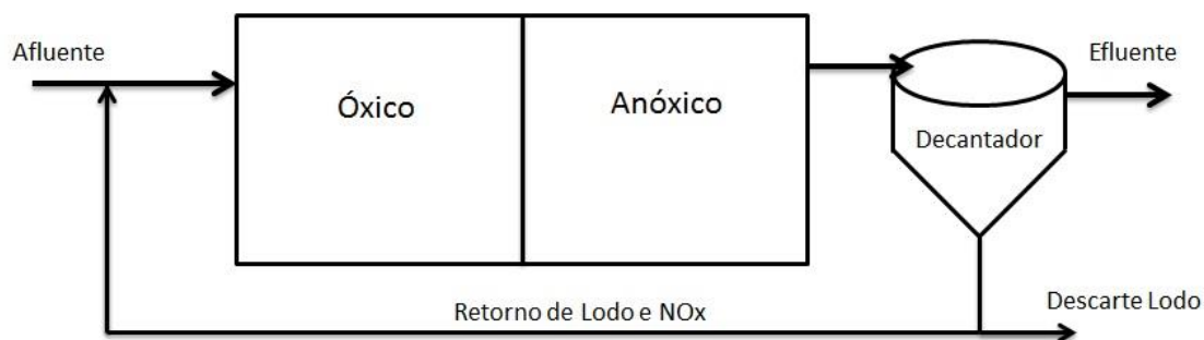
Figura 2 Representação de um sistema utilizando o processo de Desnitrificação Pós Anóxica.
