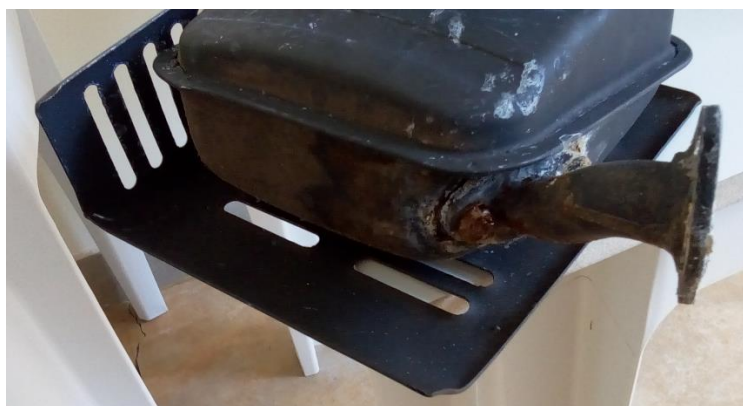
Figura 44. Sistema de exaustão apresentando sinais de oxidação.
