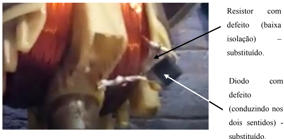
Figura 56. Detalhe dos componentes com defeito – rotor – do GMG.
