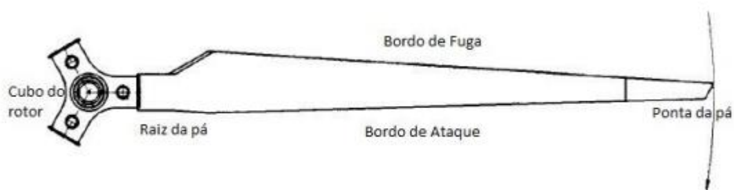
Figura 6 – Componentes de uma pá de aerogerador Fonte: Stiesdal, 1999.
