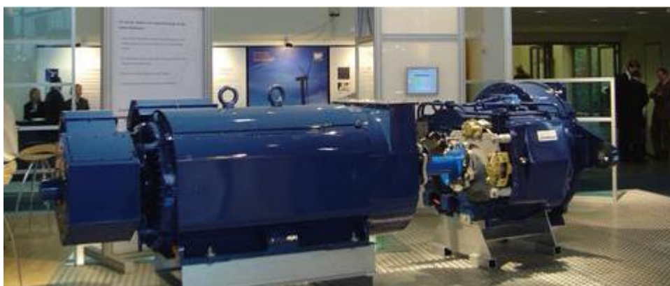
Figura 7 – Gerador conectado a caixa de engrenagens (vista à direita). Fonte: CRESESB, 2008.
