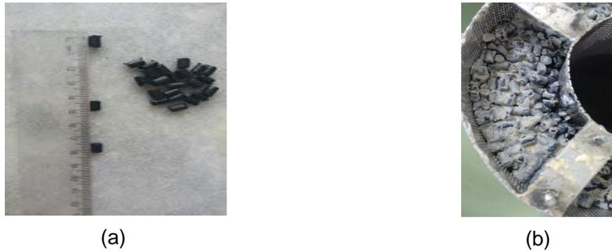
**Figura 4** Material suporte:(a) polietileno;(b) material suporte com biomassa.
