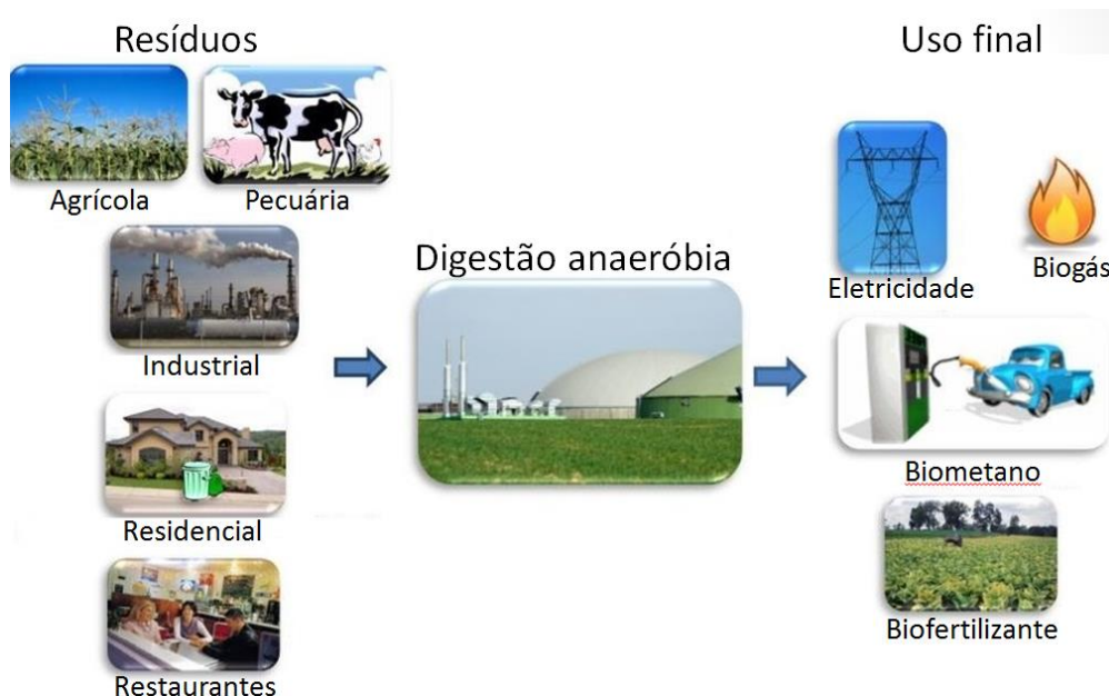
Figura 1- Ciclo do biogás: origem dos resíduos, tratamento e usos finais. Fonte: Adaptado pela autora (The EcoAmbassador, 2017).
