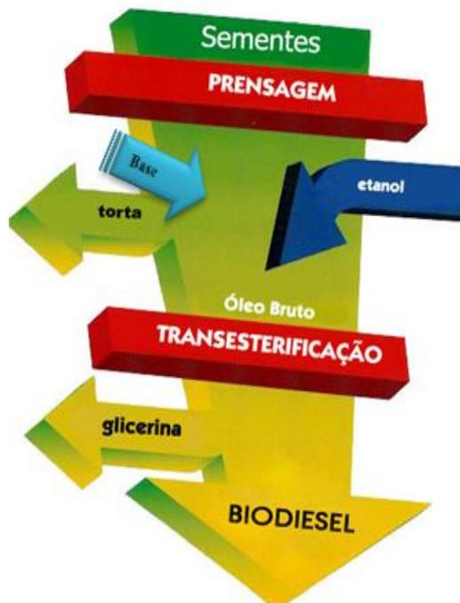
**Figura 09** - Esquema simplificado da produção de biodiesel.
