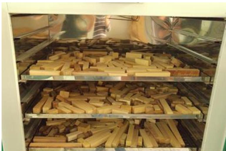
**Figura 23** – Retirada de umidade do material em estufa
