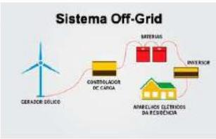
**Figura 19** Tela simulação sistema *Off-Grid*
