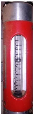
**Figura 7:** Medidor de vazão Tipo Rotâmetro Modelo BL 14.
