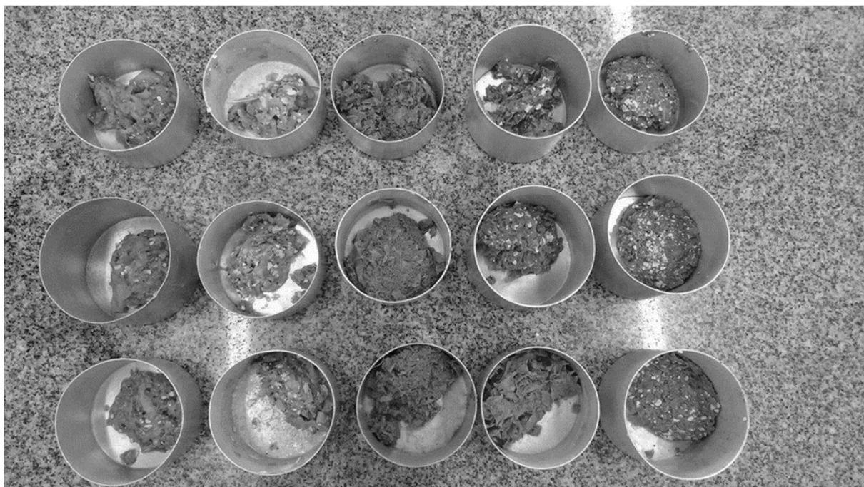
Figura 3 Característica visual da fração sólida resultante do peneiramento das reações com ácido fosfórico (100 e 90%) e ácido nítrico (100, 90 e 80%). Da esquerda para a direita: 100 e 90% ácido fosfórico; 100, 90 e 80% ácido nítrico.
