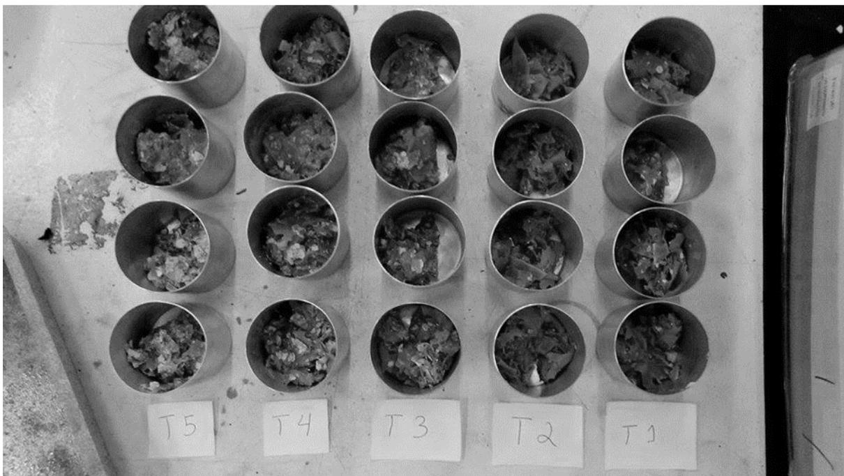
Figura 2 Aspecto do material retido na peneira (fração sólida) após a reação com ácido fosfórico, utilizada para cálculo do rendimento da dissolução da casca de ovo
