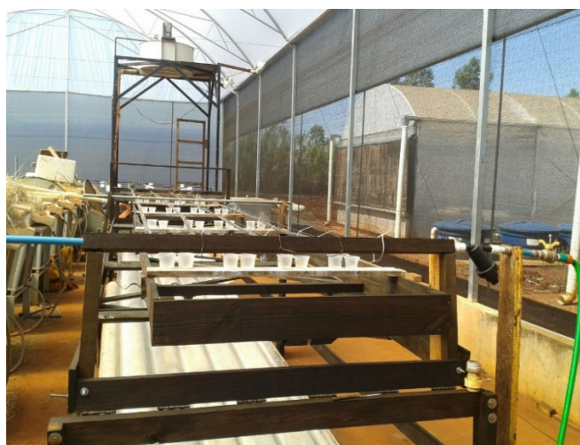
Figura 1 Bancada de ensaios de irrigação por gotejamento em ambiente controlado.
