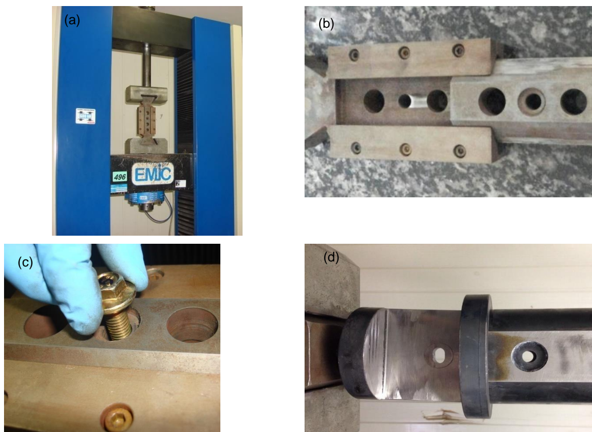
Figura 18 Ensaio de cisalhamento direto dos parafusos. a) Máquina universal de ensaios. b) Dispositivo para ensaio de cisalhamento direto do parafuso tradicional. c) Forma de inserção do parafuso no dispositivo. d) Dispositivo confeccionado para o ensaio de cisalhamento direto do parafuso alternativo.
