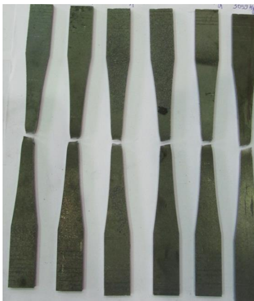
Figura 23 Ensaio de tração do aço utilizado nas chapas de apoio 4,00 mm.
