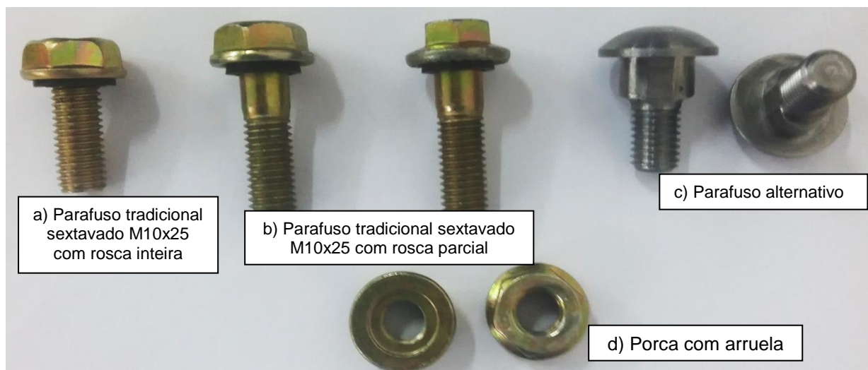
Figura 13 Parafusos para silo tradicional e parafuso alternativo.
