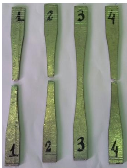
Figura 22 Ensaio de tração do aço utilizado nas chapas de apoio 3,35 mm.
