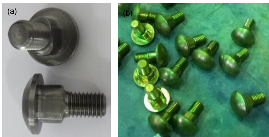
Figura 17 a) Amostra do parafuso alternativo usinado. b) Amostras após têmpera e bicromatização.
