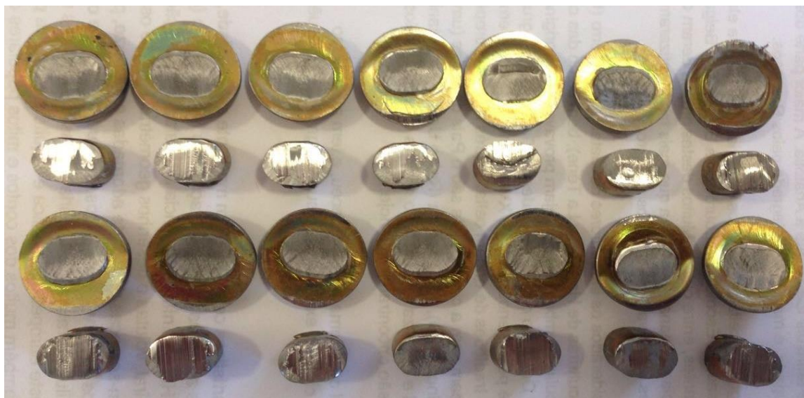
Figura 28 Corpos de prova do parafuso alternativo após ruptura por ensaio de cisalhamento direto.
