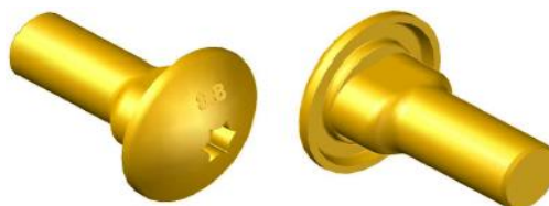
Figura 14 Representação 3D do parafuso alternativo.
