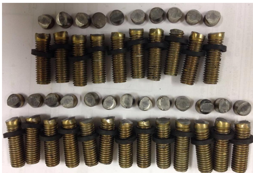
Figura 27 Corpos de prova do parafuso tradicional após ruptura por ensaio de cisalhamento direto.
