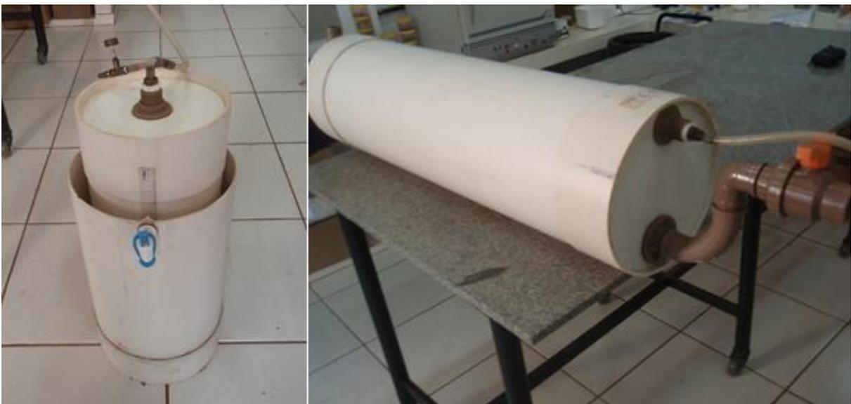
**Figura 3** À esquerda, detalhe do gasômetro com régua afixada para medição do deslocamento vertical do êmbolo e posterior cálculo do volume de biogás; À direita, foto do biodigestor e detalhe da válvula de saída do efluente e do coletor de gás.
