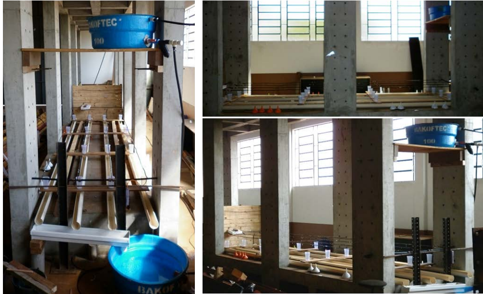
Figura 6 - Estrutura de concreto utilizada para ensaios de irrigação por gotejamento.
