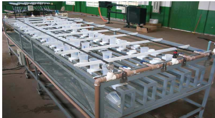
Figura 4 - Vista geral da bancada de ensaios para tubo gotejadores.
