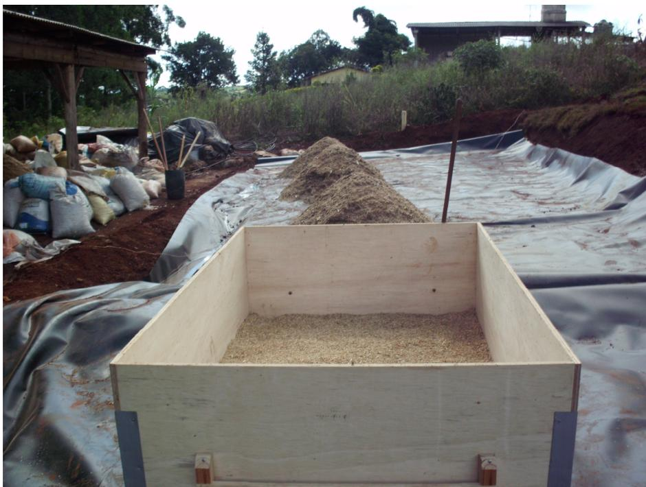
**Figura 5** Caixa em compensado naval (1,50 X 0,60 X 0,20 m) utilizada para determinação do volume das leiras.
