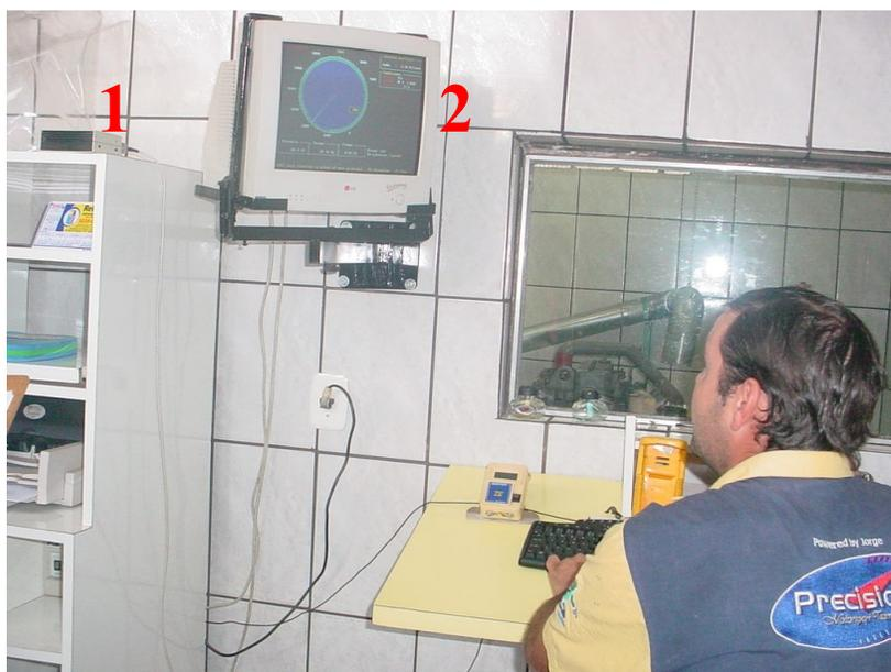
**Figura 9** - 1-) No detalhe a estação barométrica. 2-) Visualização dos parâmetros para controle do ensaio.
