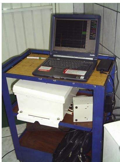
**Figura 12** - Micrologger e notebook para aquisição e armazenamento dos dados relativos a consumo de combustível.
