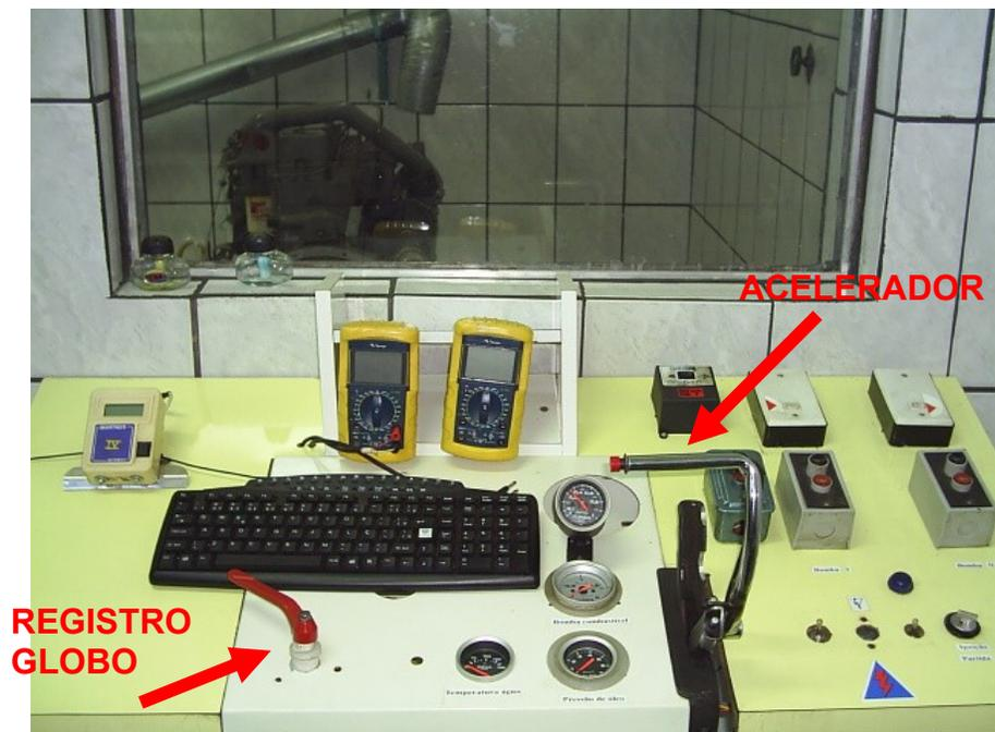
**Figura 5** - Mesa de operação e controle do dinamômetro.
