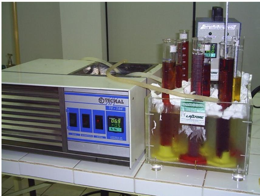
**Figura 14** – Banho eletrônico e cuba adaptada para resfriamento das amostras das misturas dos combustíveis.
