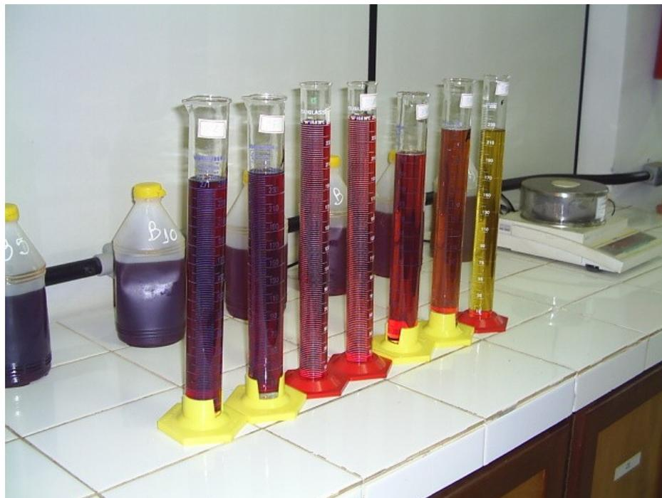
**Figura 13** – Provetas utilizadas para a determinação da variação de densidade com a temperatura das misturas diesel / biodiesel.
