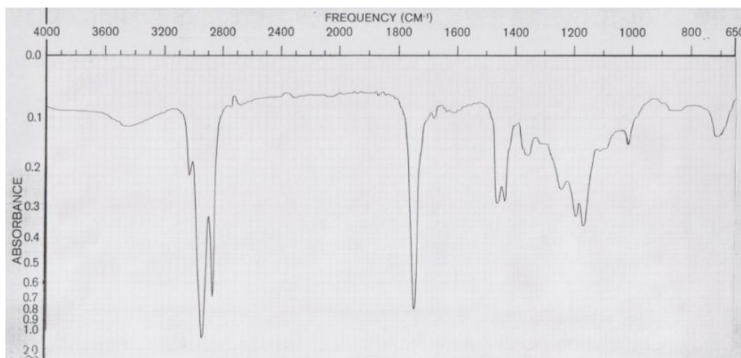
**Figura 8** - Espectro de IV do biodiesel produzido com óleo de vísceras de frango sem o processo de lavagem
