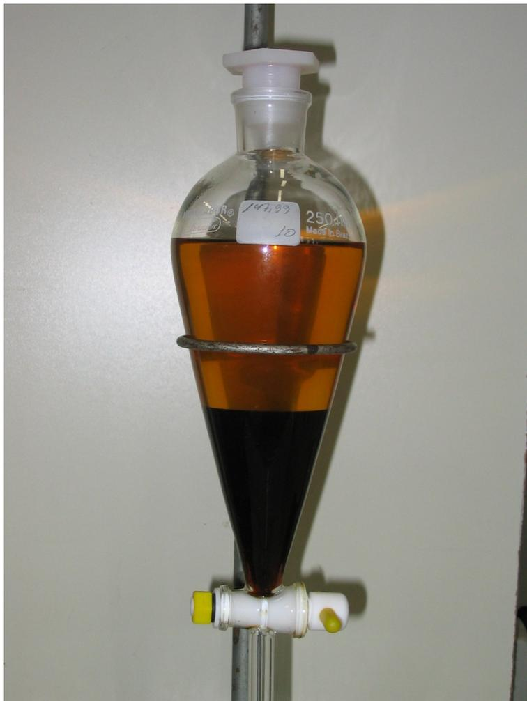
**Figura 4 -** Balão de decantação contendo biodiesel e glicerol
