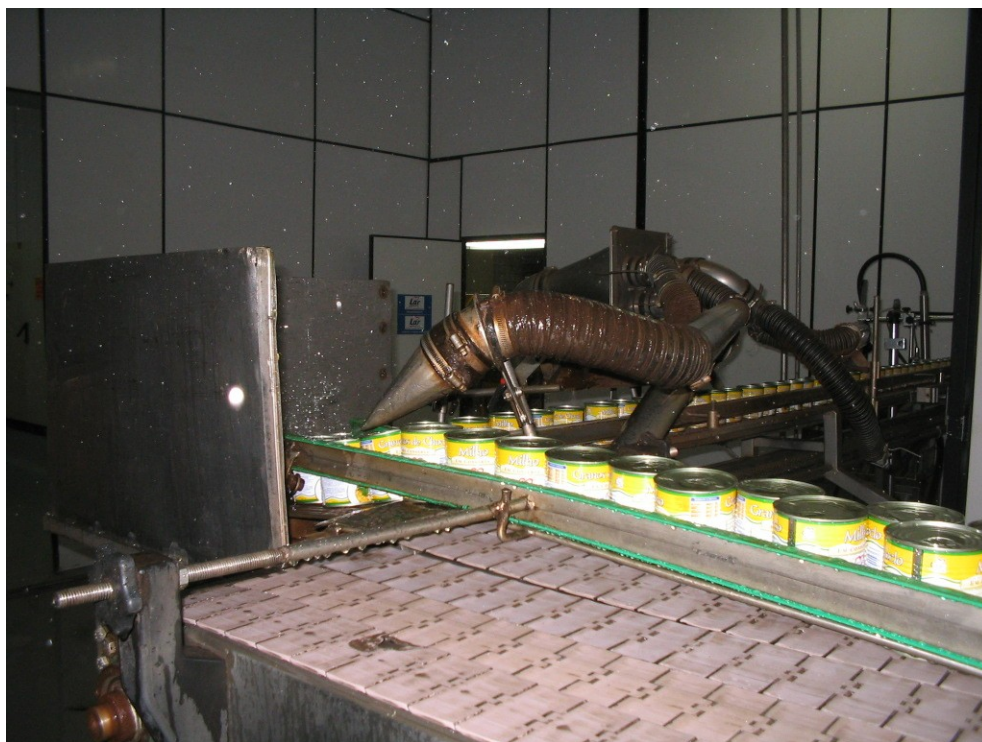
Figura 12 Etapa de secagem externa das latas.
