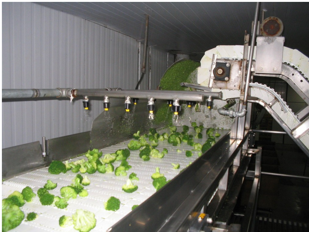
Figura 26 Vista parcial da etapa de sanitização antes do túnel de congelamento.
