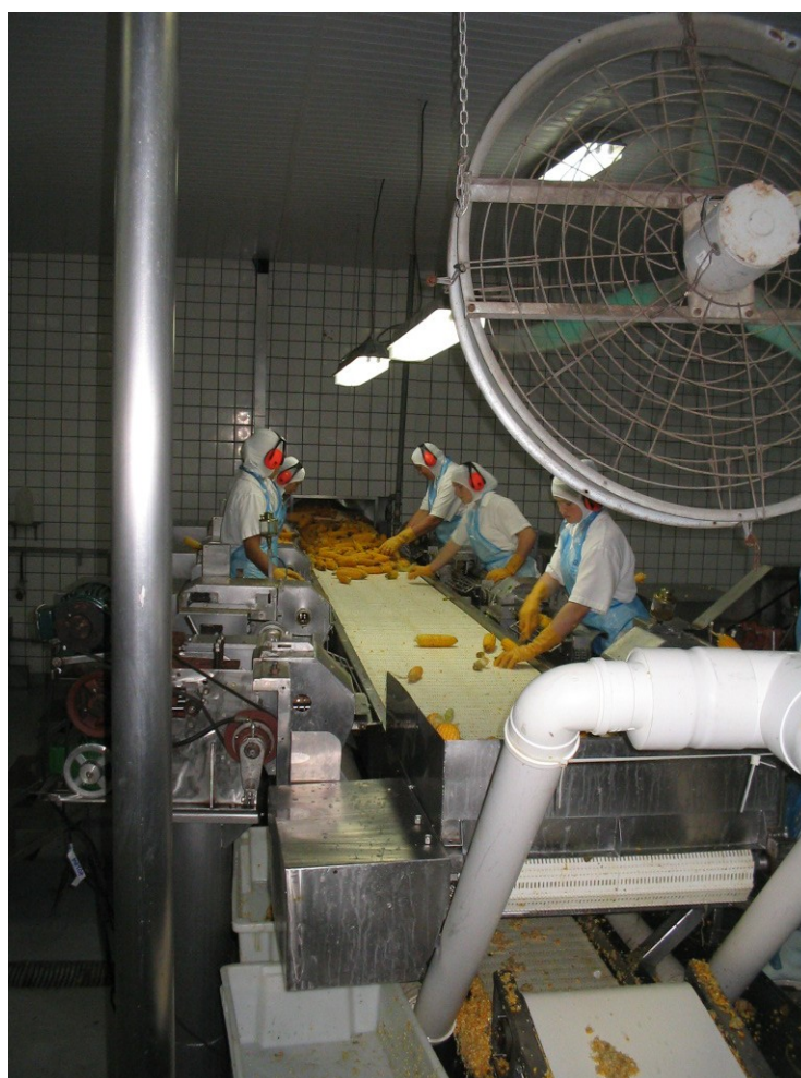
Figura 6 Vista parcial da etapa de desgranamento.
