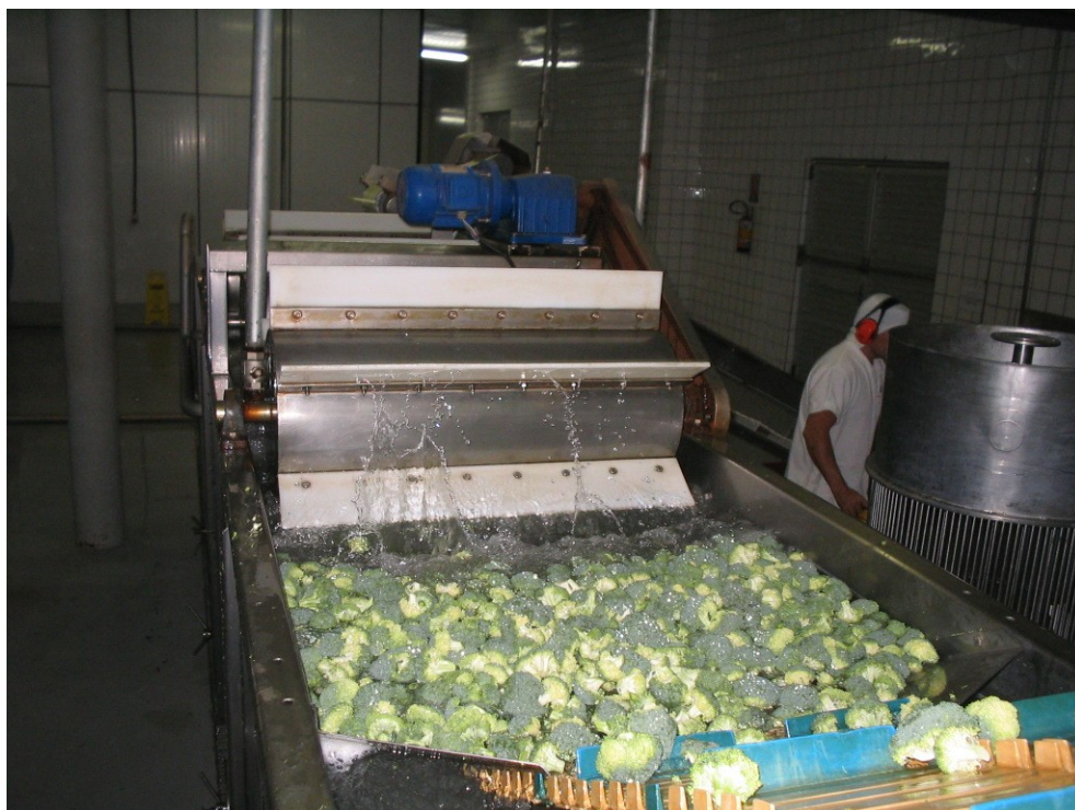
Figura 16 Vista superior do tanque de lavagem dos floretes de brócolis.
