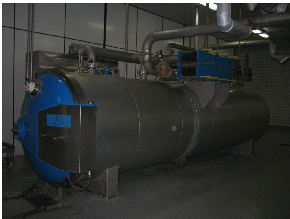
Figura 11 Detalhe da autoclave utilizada para esterilização e cozimento.
