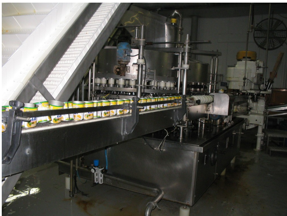
Figura 10 Transporte das latas até a envasadora. Recravação
