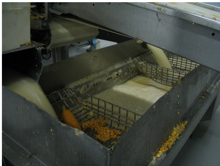
Figura 23 Detalhe do aspecto da água no tanque de desgranamento.
