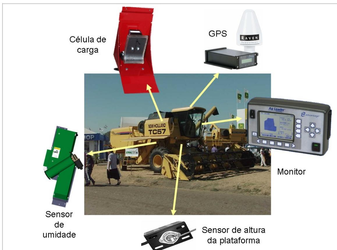
Figura 4. Colhedora equipada com sistema de monitoramento de produtividade.
