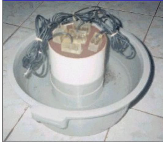
**Figura 5** Coluna de solo em processo de saturação.
