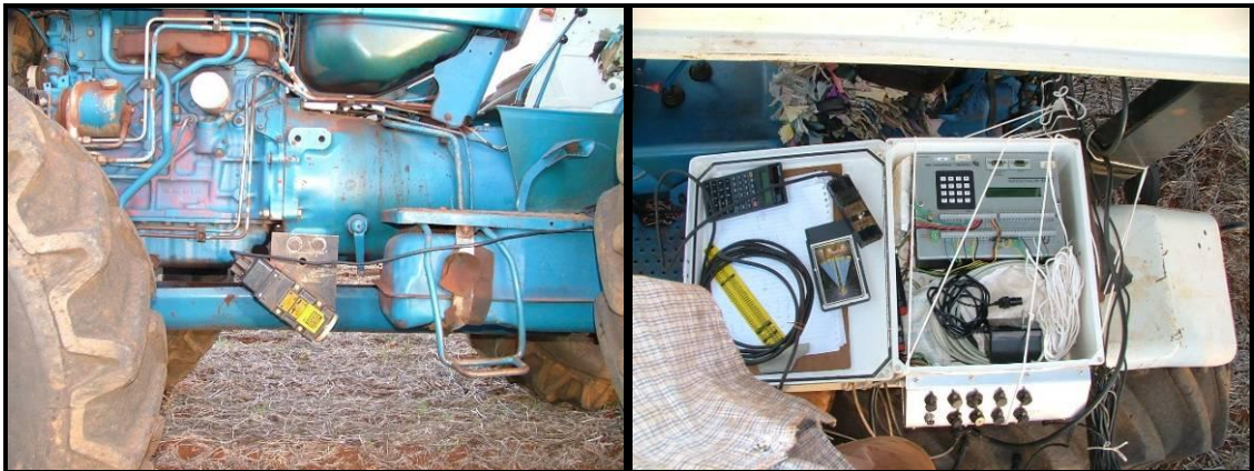
Figura 16 A Radar instalado no chassi do trator. Figura 17 A Sistema de aquisição de dados.
