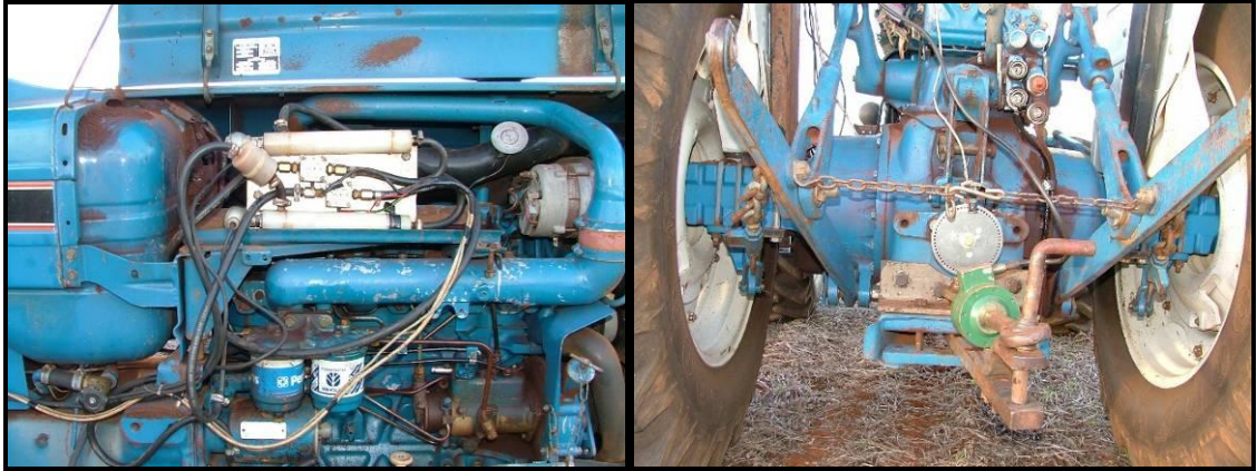
Figura 14 A Medidores de fluxo instalados no sistema de alimentação. Figura 15 A Célula de carga e sensor de rotação.
