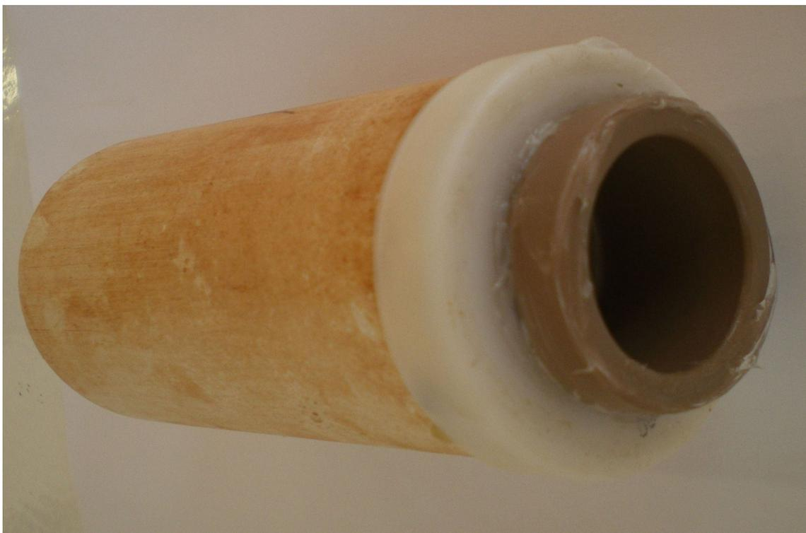
**Figura 4** Cápsula porosa montada com cap soldável e vedada com silicone, UNIOESTE, 2010.
