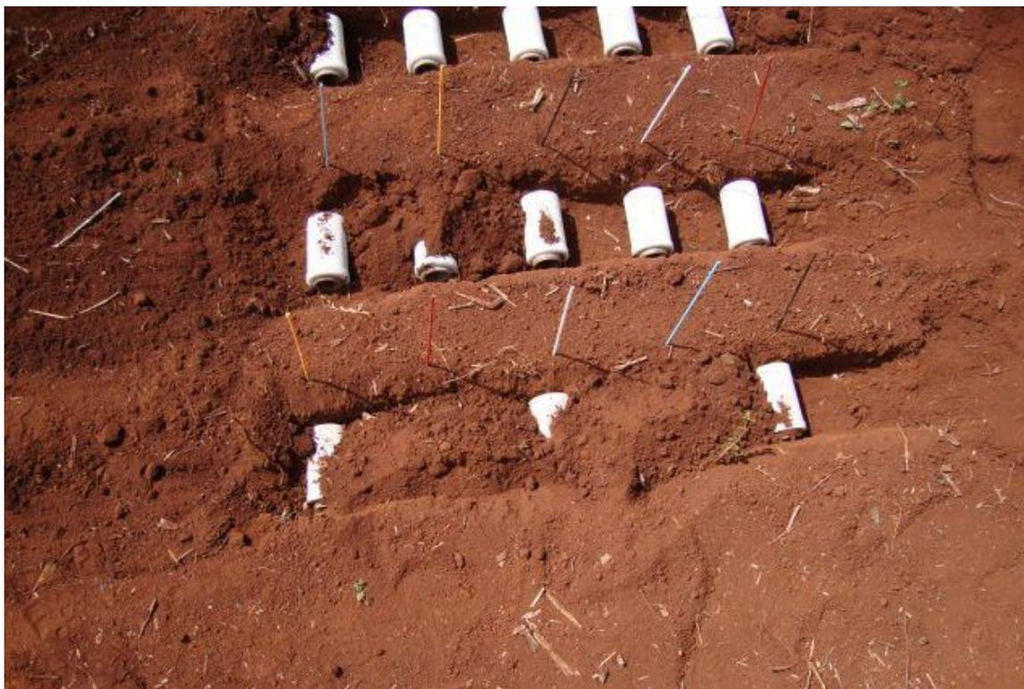
**Figura 7** Cobertura com 0,02 m de solo sobre as cápsulas porosas e identificação pela colocação de haste de madeira, com cores correspondentes aos tratamentos, NEEA, 2010.
