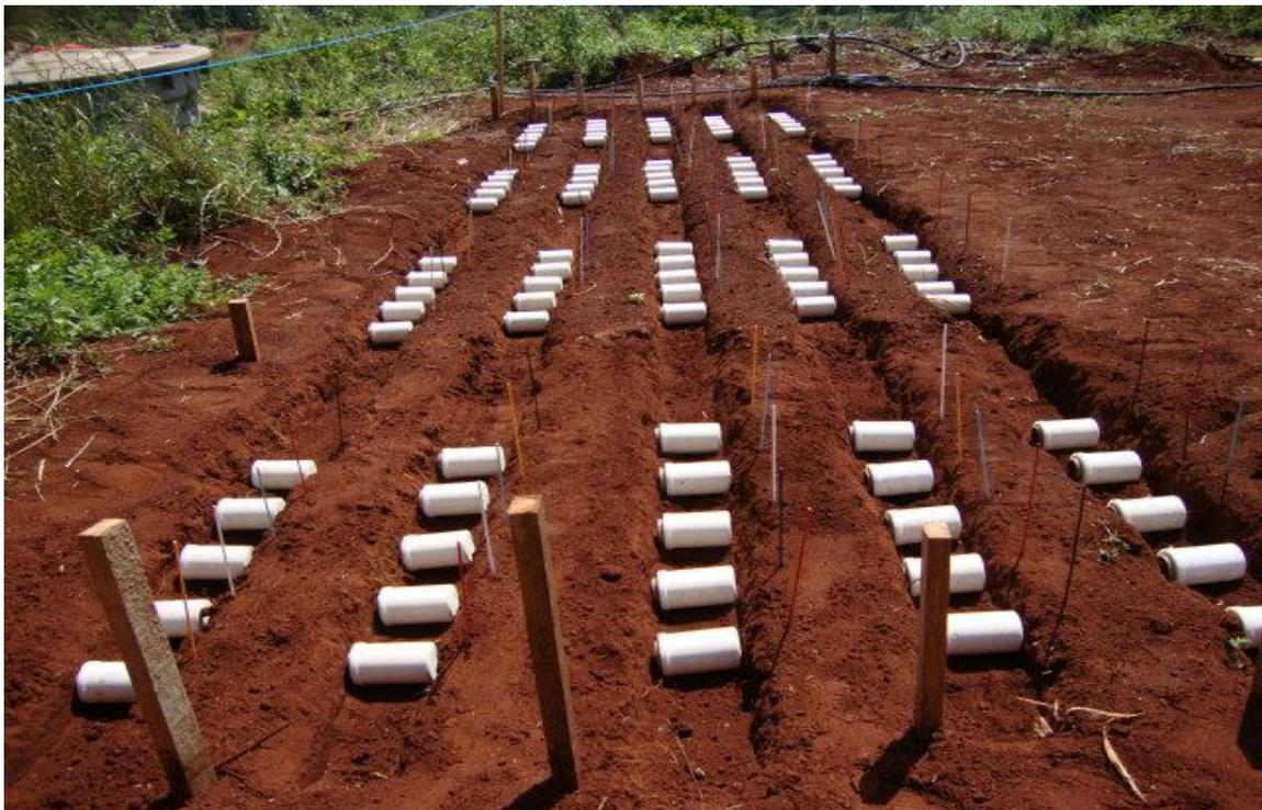
**Figura 6** Acomodação das cápsulas porosas nos sulcos, com profundidade superior ao diâmetro das cápsulas, NEEA, 2010.
