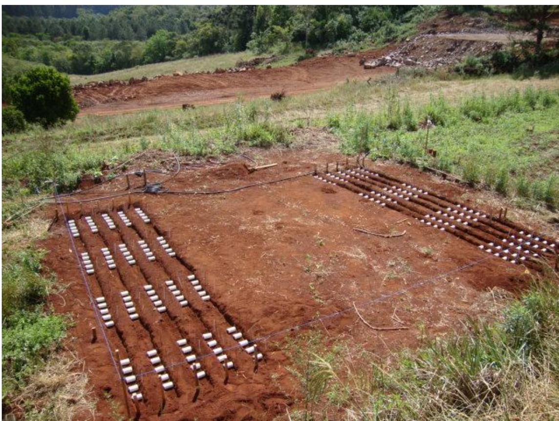
**Figura 2** Experimentos de cápsulas porosas com adubos orgânicos, com e sem irrigação, verão e outono, NEEA, 2010.
