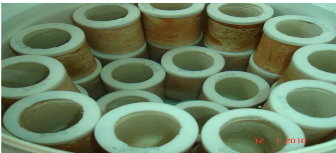
**Figura 5** Cápsulas porosas imersas em água, UNIOESTE, 2010.
