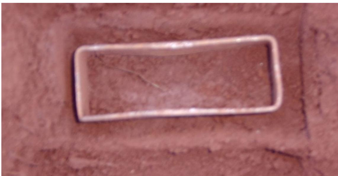
**Figura 11** Amostrador metálico utilizado para remoção do solo sob as cápsulas porosas, NEEA, 2010.
