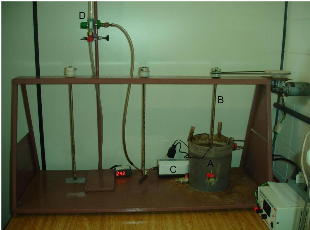
**Figura 1** Reator em Bateladas Sequenciais (A-RBS; B-Agitador; C-Aerador; D-Fluxômetro).
