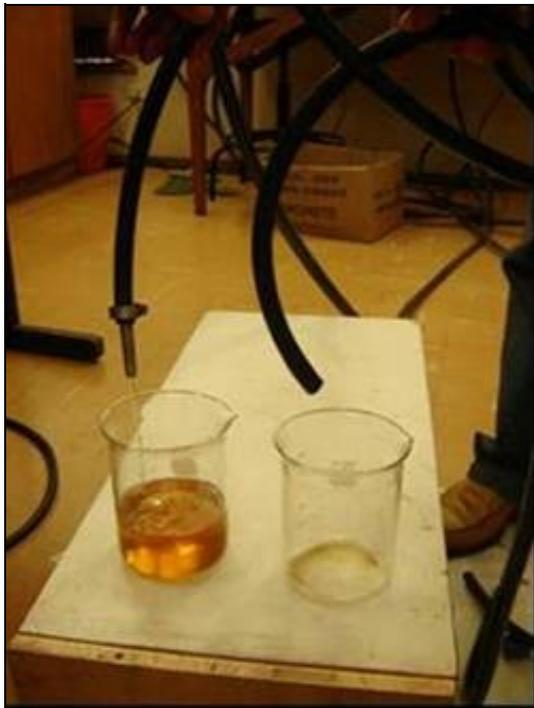
**Figura 22** - Retorno do combustível do tanque 1.
