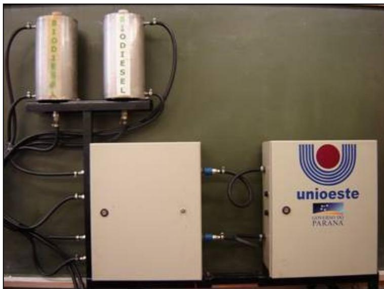
**Figura 16** - Vista frontal do sistema automatizado, composto pelos tanques auxiliares e quadros de controle e medição.
