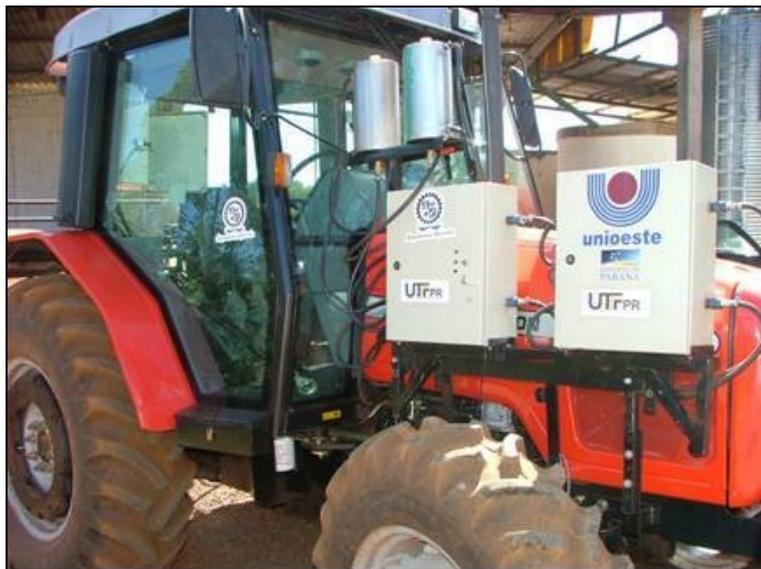
**Figura 17** - Montagem do sistema automatizado para avaliação do consumo de biodiesel de tratores agrícolas no trator Massey Ferguson.
