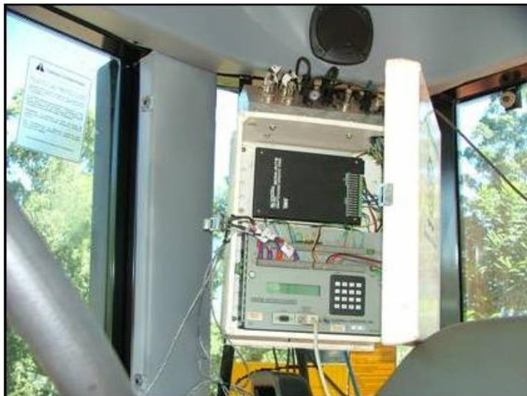
**Figura 10** - Sistema de aquisição de dados montado na cabine do trator de ensaio.
