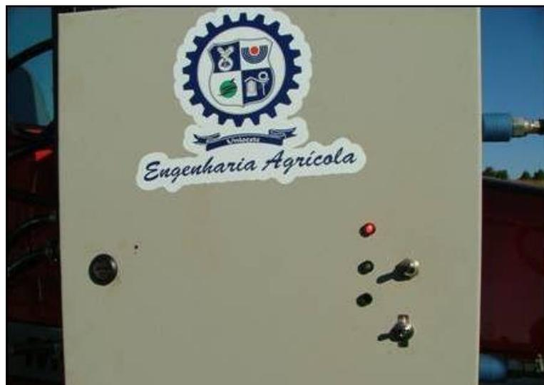
**Figura 25** - Quadro de controle com a identificação dos led's referente ao tanque de alimentação 1.
