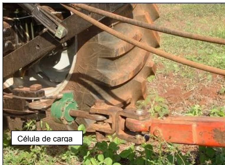
**Figura 19** - Célula de carga.
