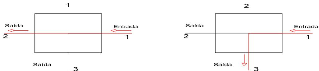
condição ligada 1 e desligada 2. Orifícios de entrada – 1; orifícios de saída – 2 e 3.
