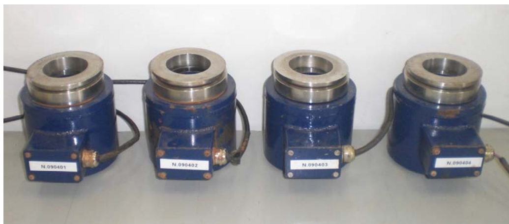
Figura 16 Células de pressão utilizadas no experimento.
