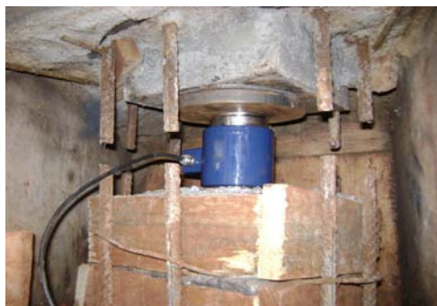
Figura 21 Célula de pressão devidamente posicionada.
