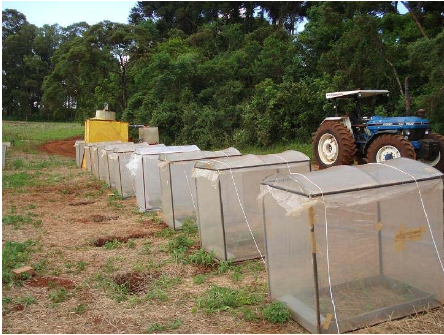
Figura 2 Vista da área das parcelas experimentais protegidas por mini-estufas para o controle hidrológico
