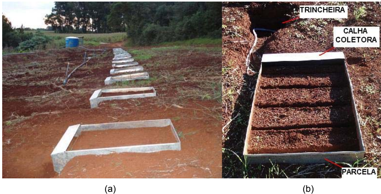
Figura 1 Vista da área experimental (a) e identificação das partes parcela experimental, calha coletora e trincheira (b).
