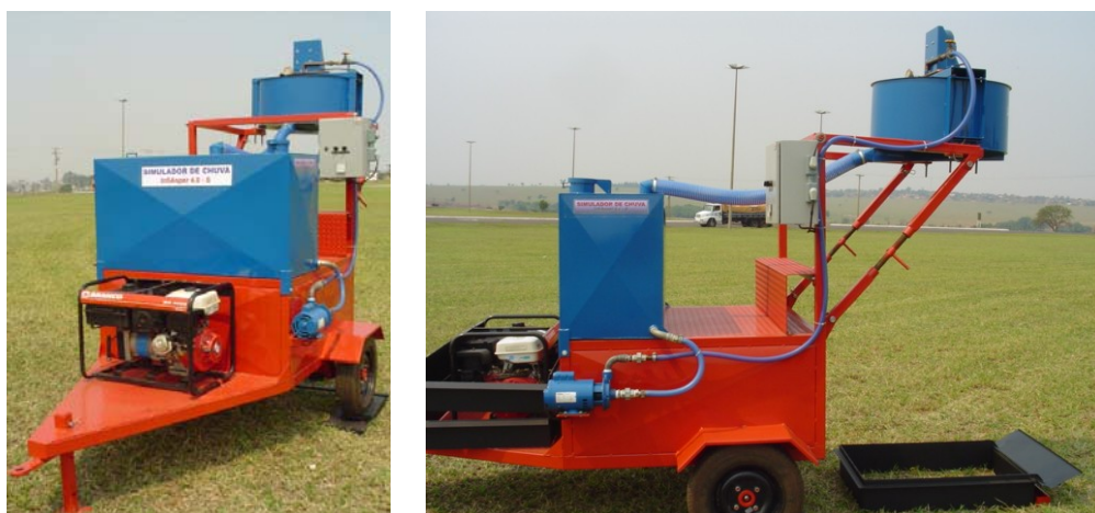
Figura 3 Simulador de chuvas InfiAsper/UFMS.
