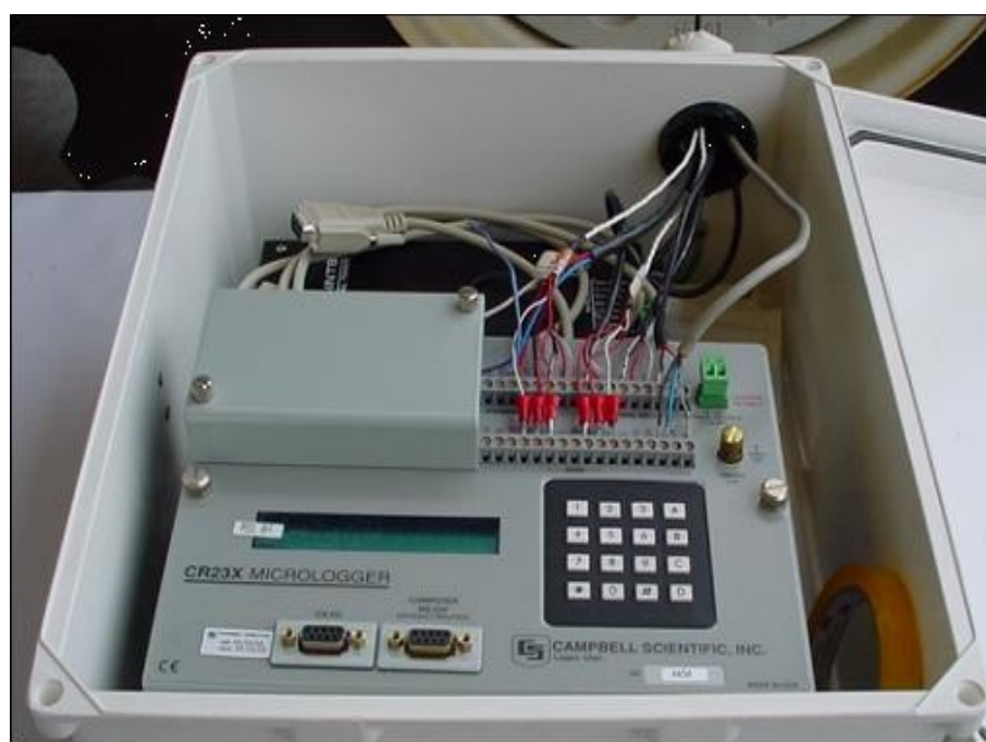
Figura 5 - Sistema de aquisição de dados ligado aos sensores.
