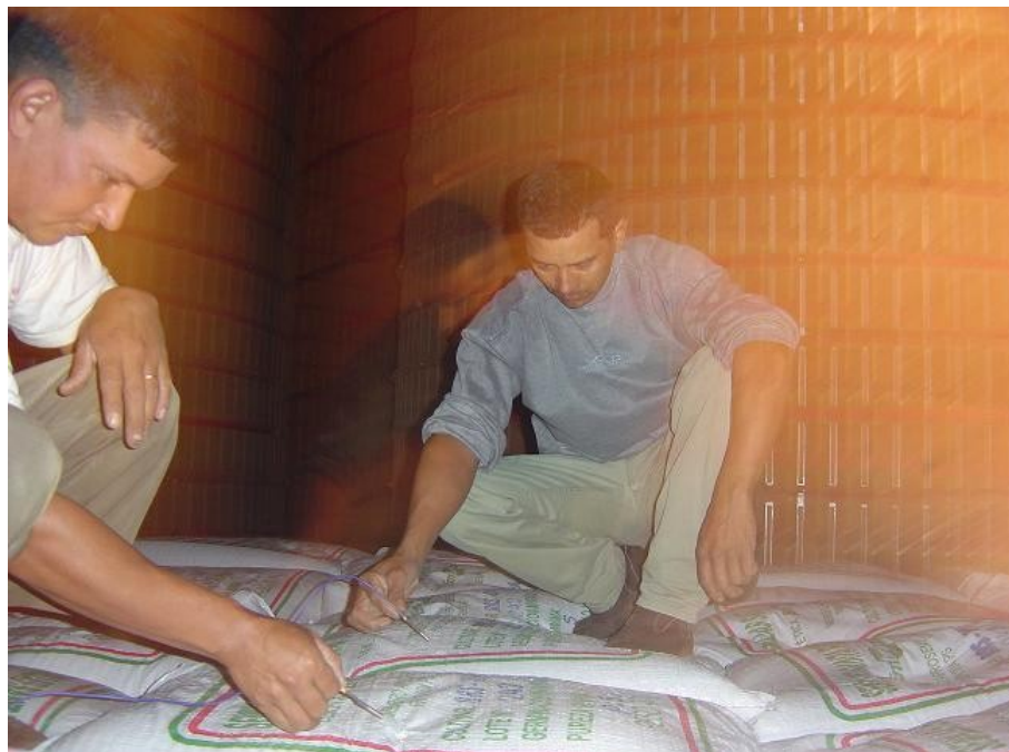
Figura 1.3 - Instalação dos sensores nos sacos de sementes.
