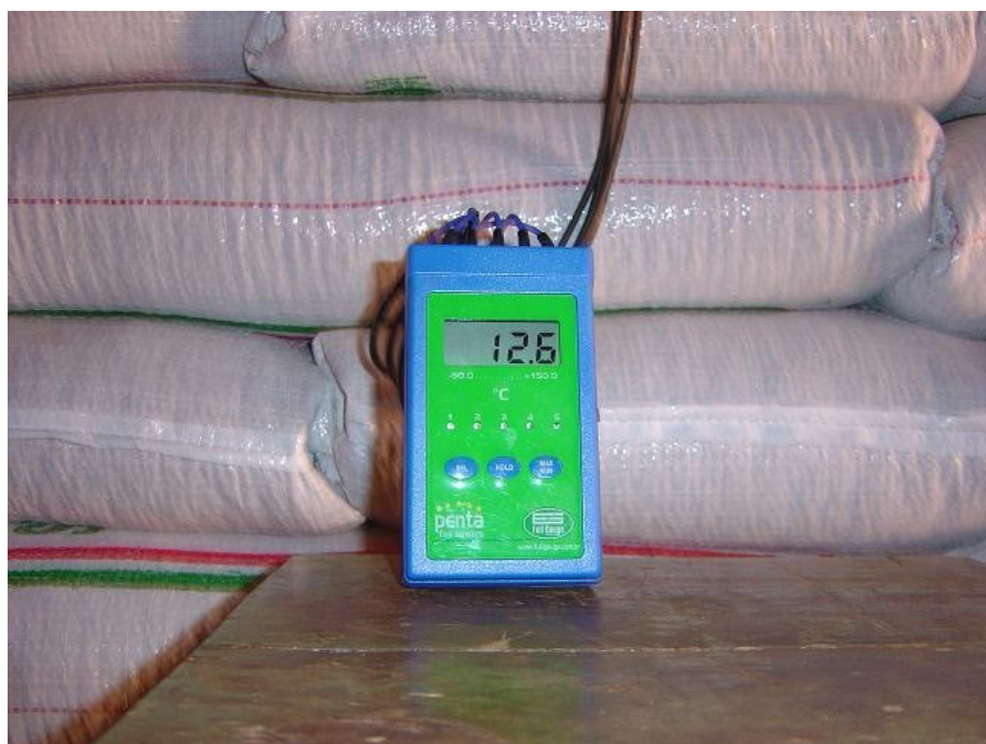
Figura 1.4 Equipamento de leitura das temperaturas nas diferentes profundidades dos blocos de sementes.
