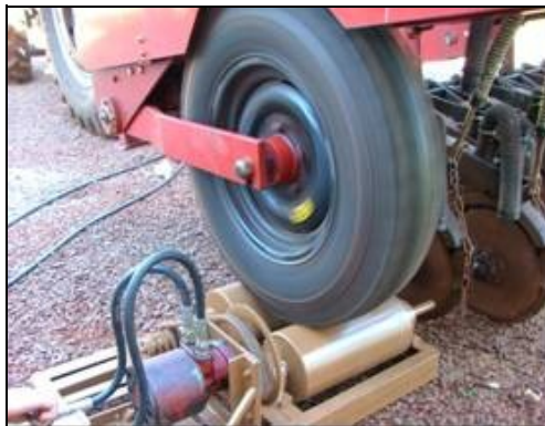
Figura 17 - Simulação das velocidades de deslocamento do conjunto trator/semeadora pela bancada estacionária.
