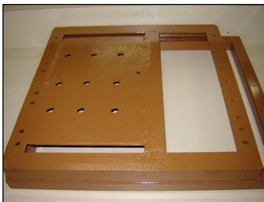
Figura 1 - Estrutura metálica montada para a bancada de ensaio.
