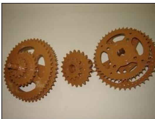
Figura 4 - Jogo de engrenagens de aço carbono com diferentes espaçamentos entre elos (asa 40 e 60).
