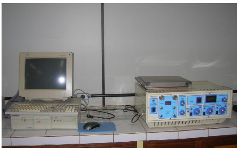
**Figura 8** Aparelho de Cromatografia gasosa marca Construmaq, para cromatografia gasosa de alta resolução (CGAR).
