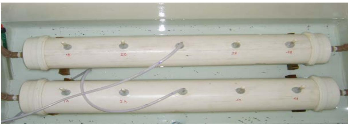
**Figura 5** Reatores feitos com tubos de PVC comprimento x largura 1 m x 0,15 m.
