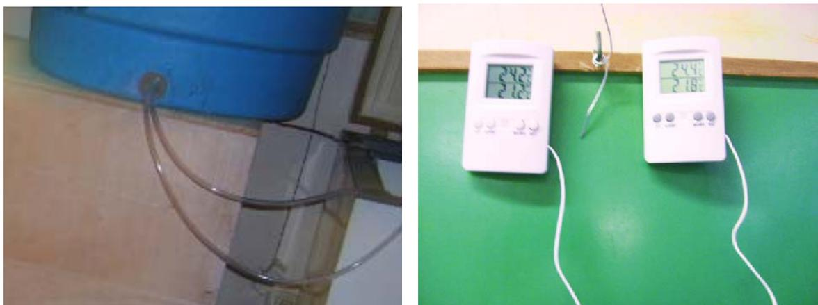
**Figura 7** Detalhe da tubulação de biogás na abertura da caixa de água e termômetros digitais INCOTERM (precisão 0,1 °C) que monitoram a temperatura do ambiente e do biogás no interior dos gasômetros.
