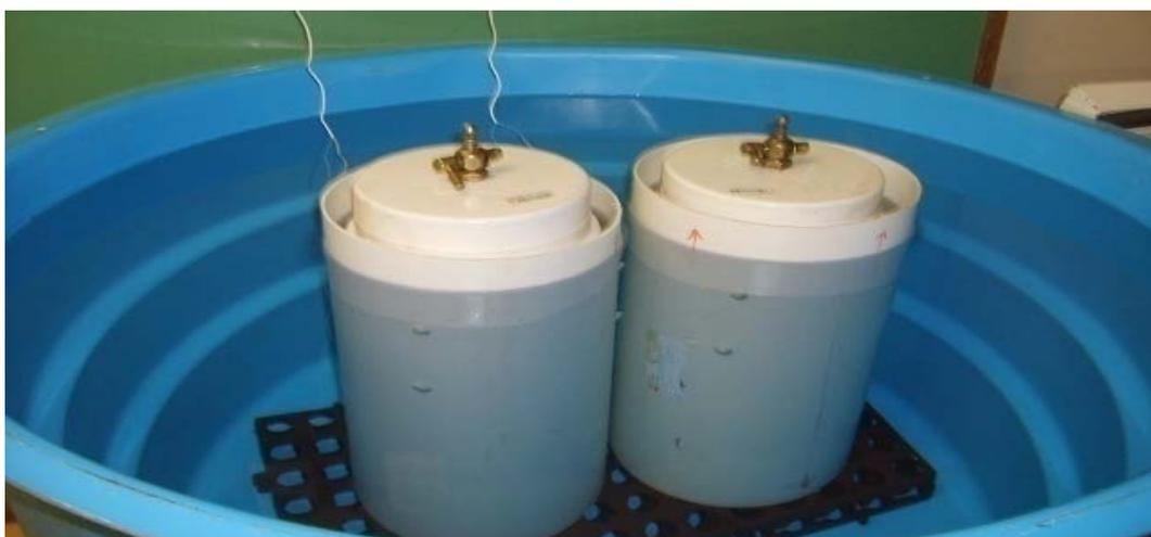
**Figura 6** Gasômetros em tubos de PVC d 250 mm no interior de tubos guias de 300 mm de diâmetro interno, sobre estrado de PVC.
