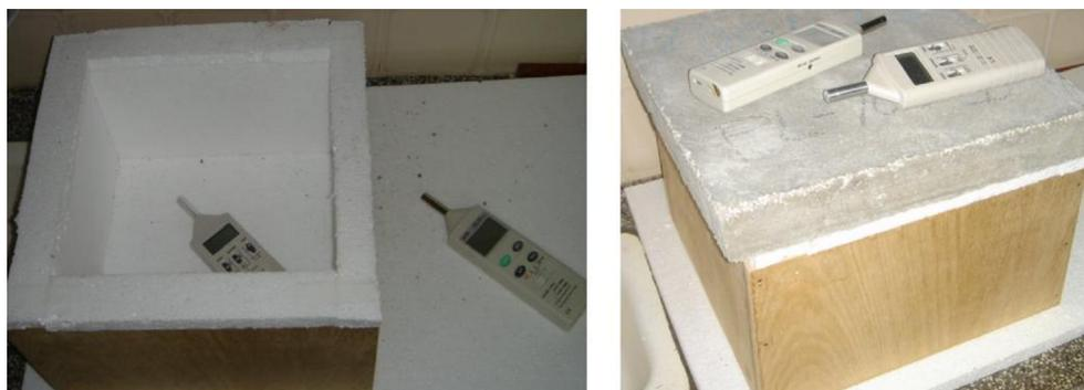
**Figura 10** - Posição dos decibelímetros, interno e externo e da caixa sem a placa de concreto e com a placa de concreto como tampa.
