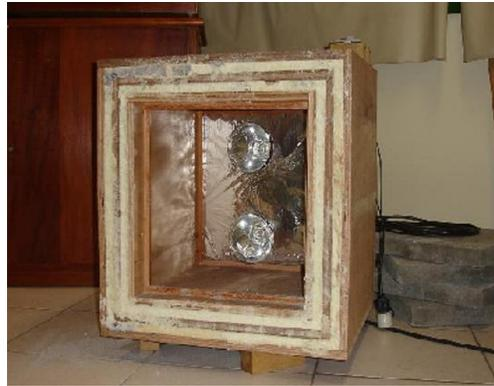
**Figura 7** - Caixa térmica e fonte de calor radiante.
