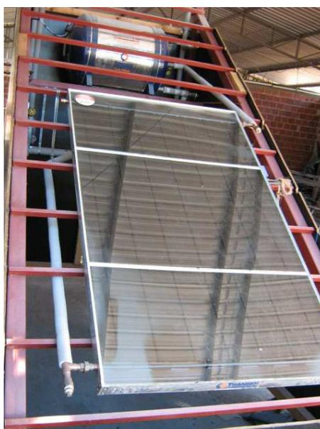
**Figura 11** - Coletor solar.
