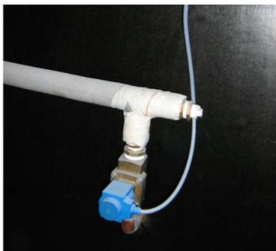
**Figura 14** - Válvula solenóide.
