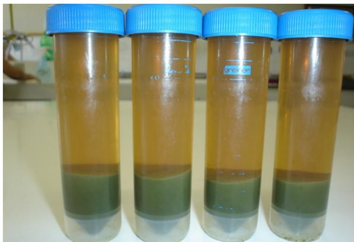
**Figura 7** - Líquido sobrenadante e concentrado protéico, depois da centrifugação.
