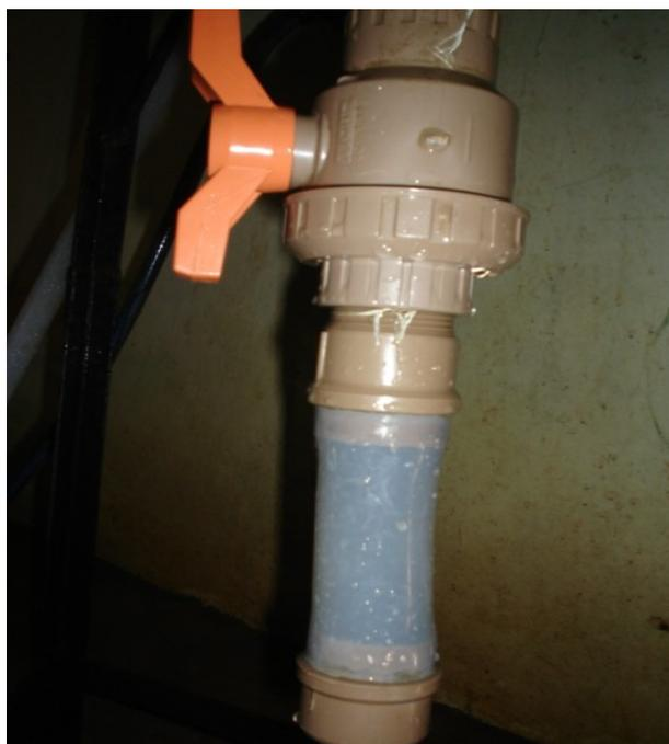
**Figura 10** - Válvula de abertura e sifão para coleta das excretas.
