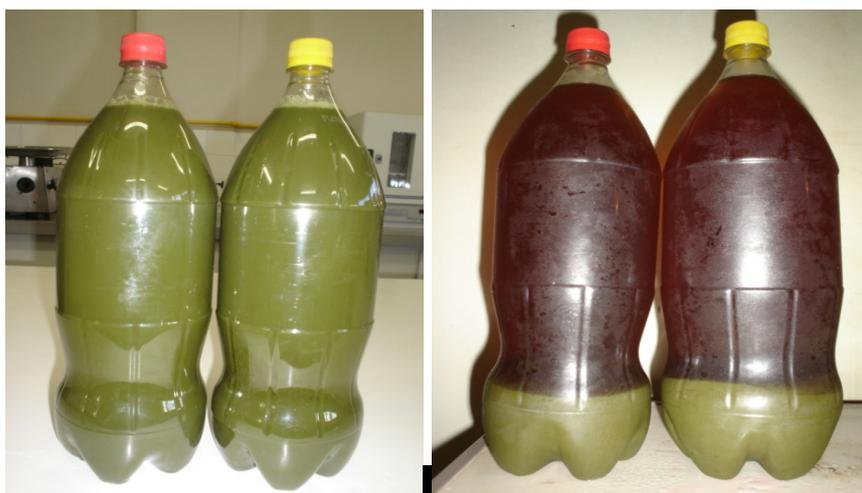
**Figura 6** - Suco de folhas (à esquerda) e sobrenadante e precipitado após repouso por 24 horas a 4°C (à direita).
