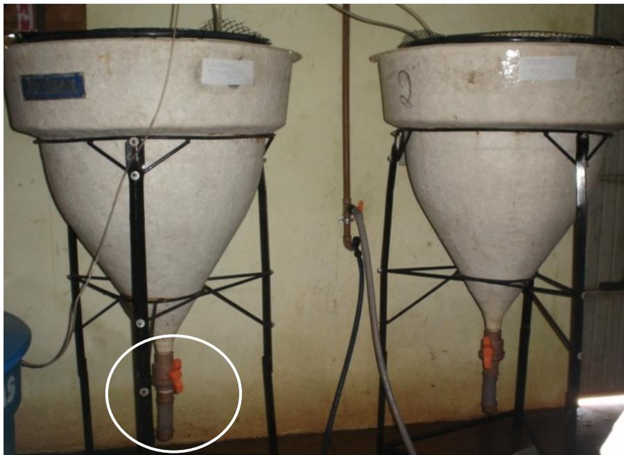
**Figura 9** - Tanques de coleta de 150 L. No detalhe: sifão na extremidade inferior.
