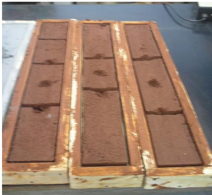
Figura 8 - Foto ilustrativa do teste da caixa, utilizado para determinação do índice de retração.
