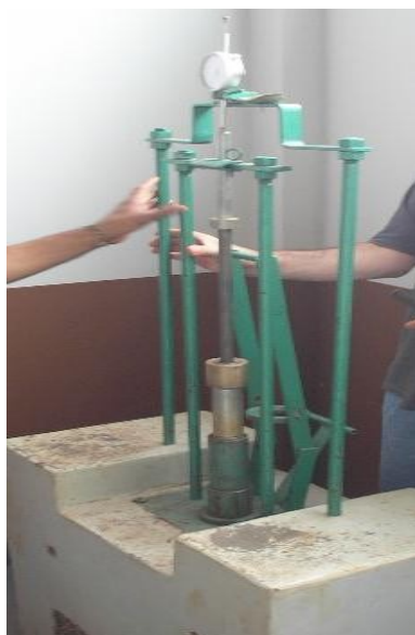
Figura 10 - Foto do mini MCV, aparelho utilizado para a moldagem dos corpos-de-prova de propriedade do DER (Departamento de Estradas e Rodagem).
