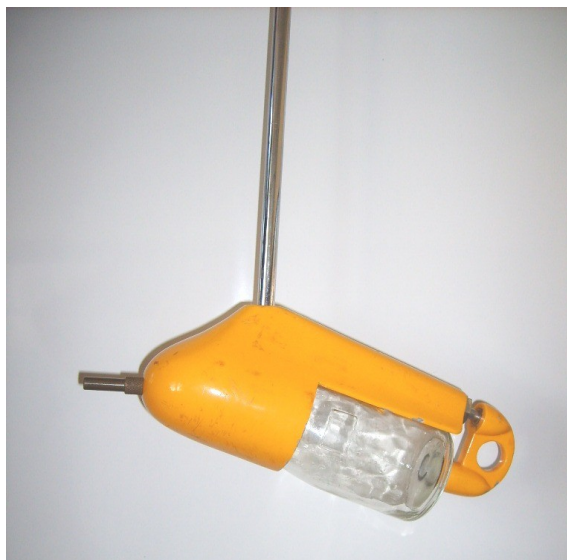
Figura 06 Amostrador de sedimentos em suspensão DH 48.
