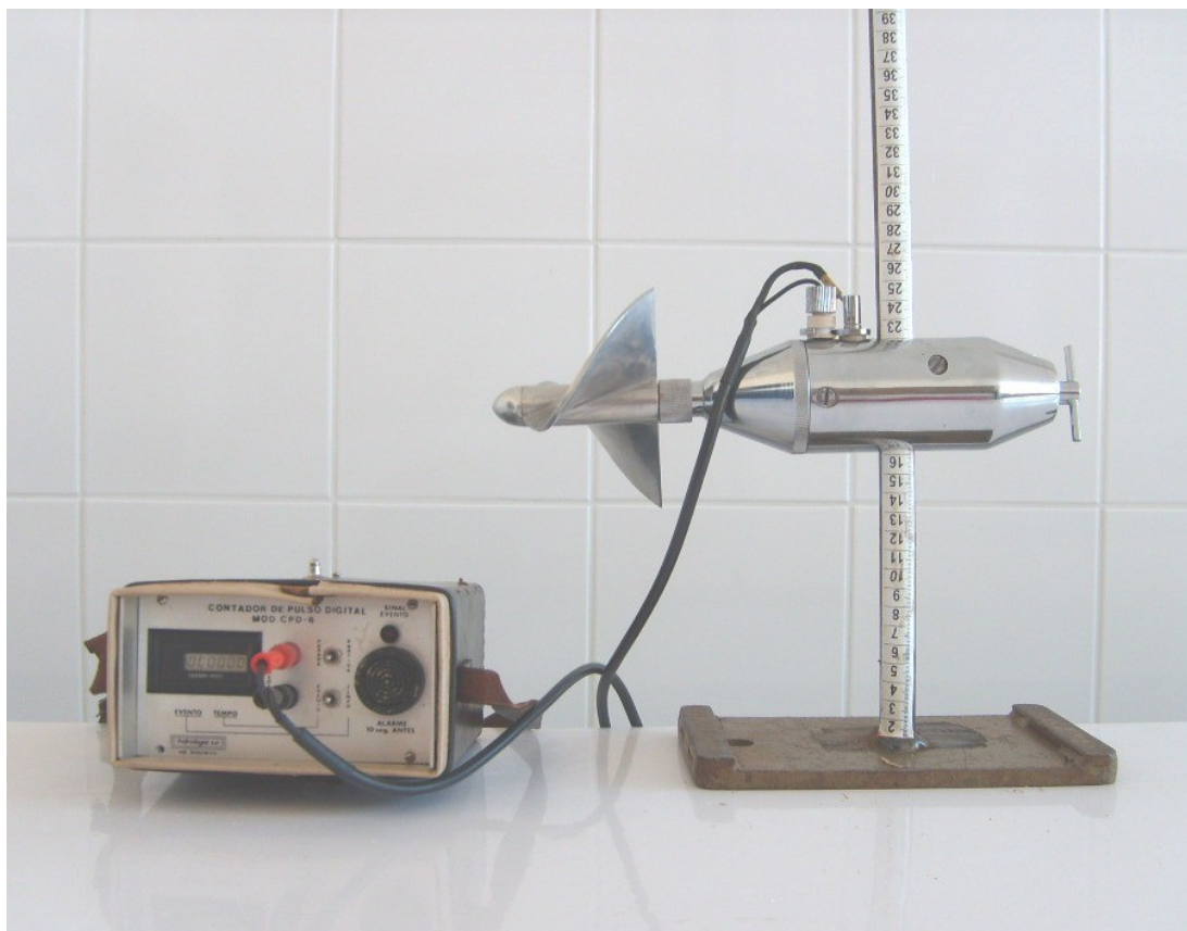
Figura 05 Molinete MLN-07 e contador de pulsos.
