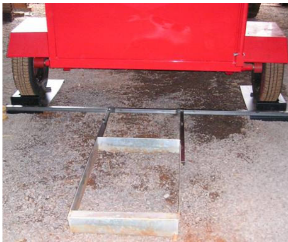
Figura 8 Gabarito desenvolvido por NASCIMENTO (2005) e utilizado para a centralização do simulador de chuvas na parcela.
