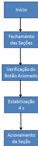
Figura 4 Fluxograma da transição entre os diferentes circuitos do protótipo.
