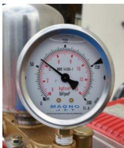
Figura 8 Manômetro utilizado para aferição da pressão de trabalho no momento dos testes do protótipo.
