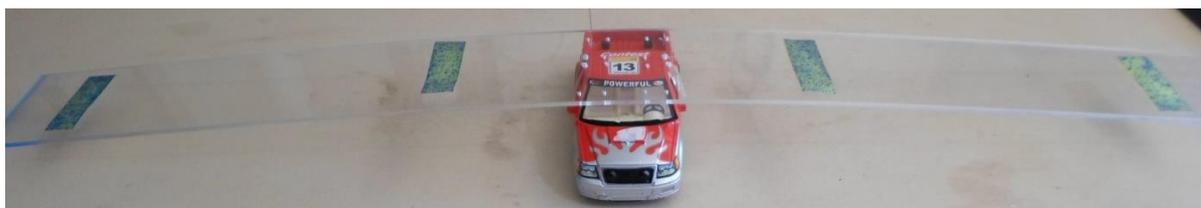
Figura 10 Mini carro de controle remoto utilizado para a coleta dos papéis hidro sensíveis.
