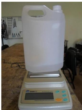
Figura 9 Pesagem do volume após a coleta da vazão.
