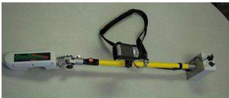
Figura 7. Medidor de índice de vegetação GreenSeeker.
