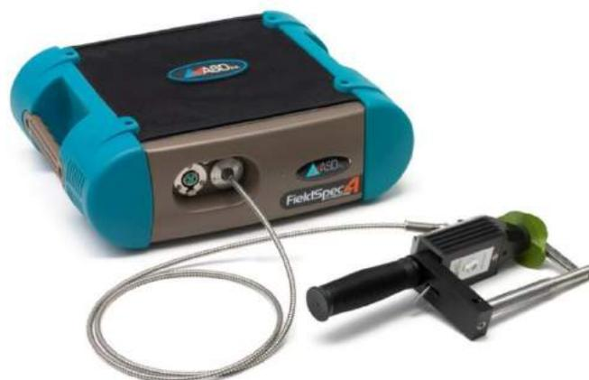
Figura 9. Sensor óptico multiespectral FieldSpec 4.
