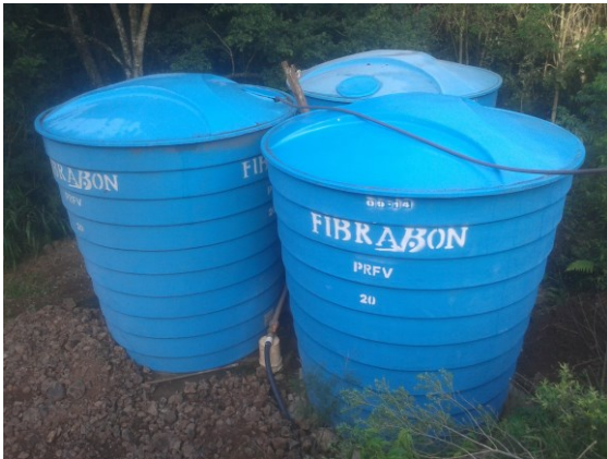
Figura 5 a) Reservatórios de digestato; b) Sistema de agitação do digestato armazenado.
