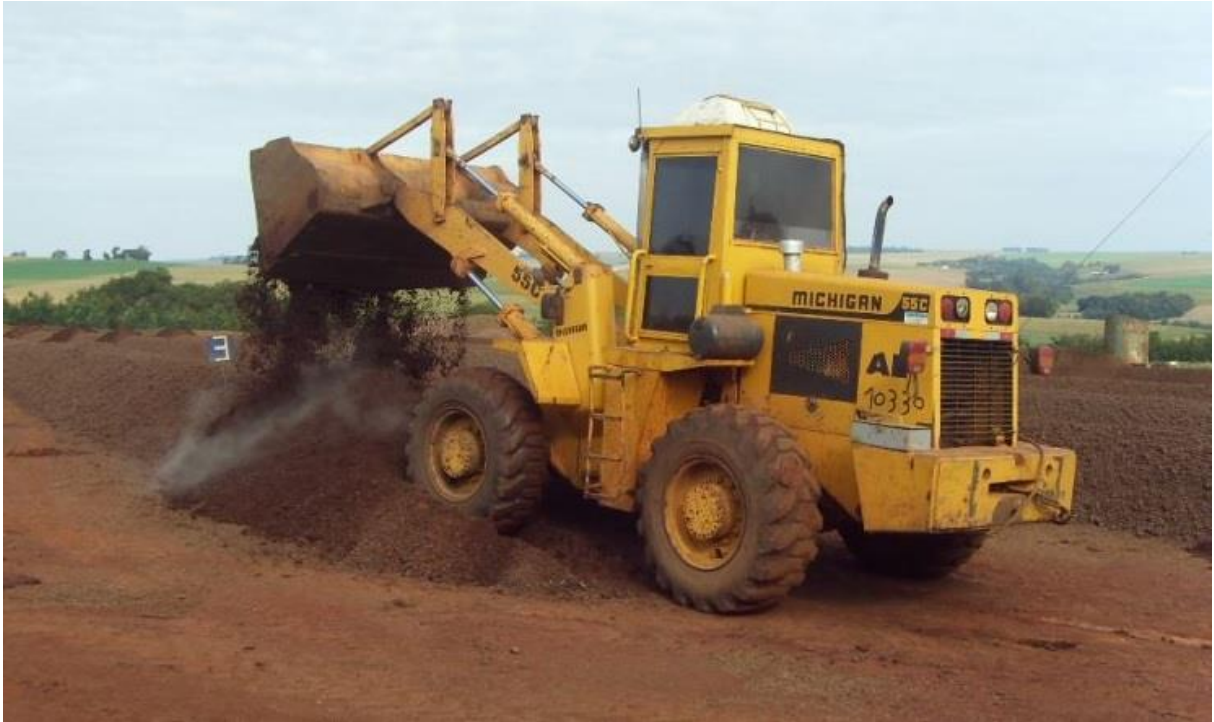
Figura 3. Pá carregadeira utilizada na montagem das leiras
