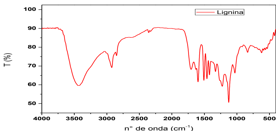
Figura 3 Espectro de absorção na região de infravermelho da lignina precipitada do licor negro resultante da produção de bioetanol.
