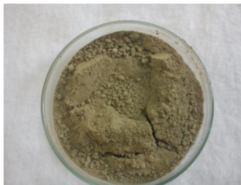
Figura 2 Lignina separada por precipitação do licor negro resultante do processo de deslignificação da produção de bioetanol.
