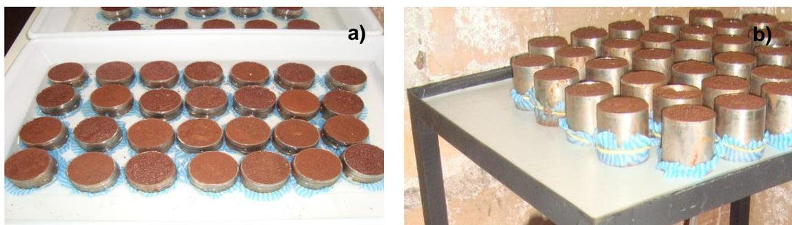
**Figura 10** Amostras colocadas para saturação (a) e mesa de tensão (b).
