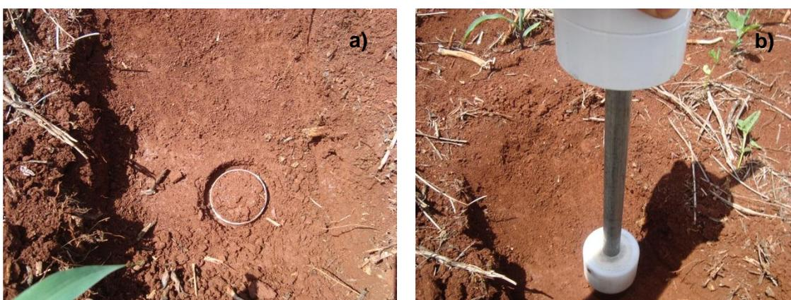
**Figura 9** Retirada de amostra para determinação da densidade do solo por meio de anel volumétrico.
