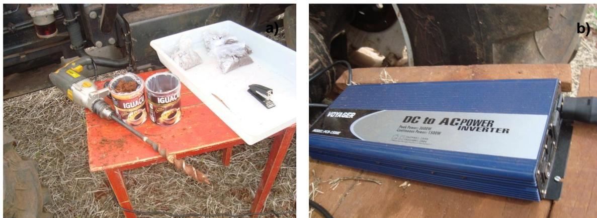
**Figura 13** Furadeira com trado (a) e inversor de frequência (b).
