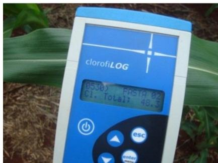
**Figura 14** Medidor de clorofila - ClorofiLOG.
