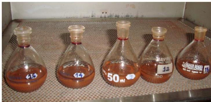
**Figura 11** Picnômetros utilizados na determinação da densidade de partículas.
