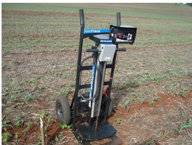
**Figura 12** Penetrômetro SoloTrack.
