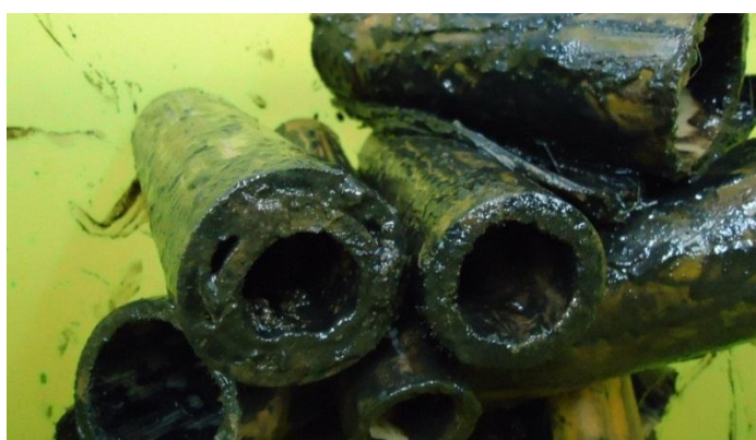
Figura 3 Lodo anaeróbio aderido a anéis de bambu provenientes de biodigestor
