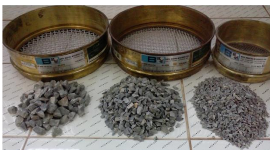
Figura 10 Granulometrias das pedras de calcário utilizadas no teste de dissolução
