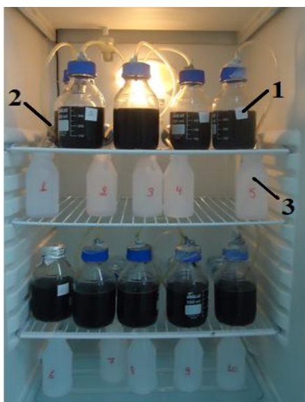
Figura 9 Aparato experimental utilizado no teste AME: frascos de reação (1); gasômetros (2); frascos de coleta de NaOH (descarte) (3)
