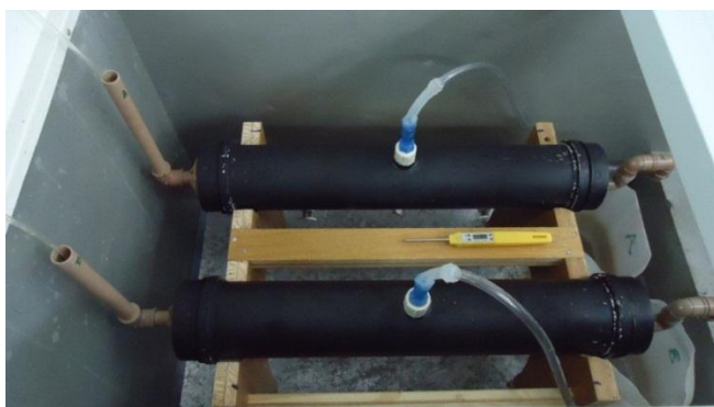
Figura 12 Reatores anaeróbios no interior da caixa térmica
