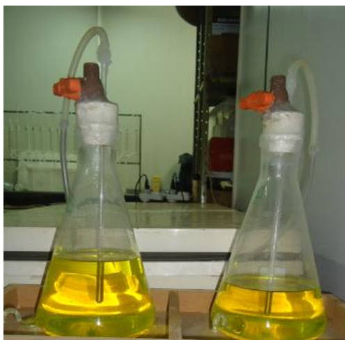
Figura 3 Gasômetros tipo Mariotte contendo solução ácido-salina
